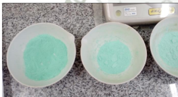
Fotografías del proceso de síntesis del catalizador Ni-Cu/Alúmina.
