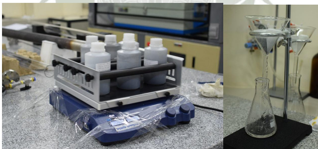
Fotografías del sistema de agitación múltiple y filtración en los ensayos de adsorción de plomo.
