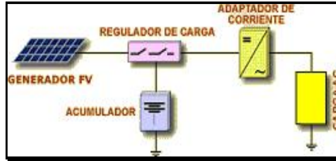
Figura 23: Topología de sistema fotovoltaico para cargas DC y AC
