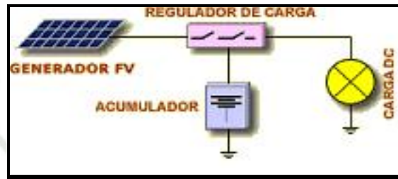
Figura 22: Topología de sistema fotovoltaico para cargas DC
