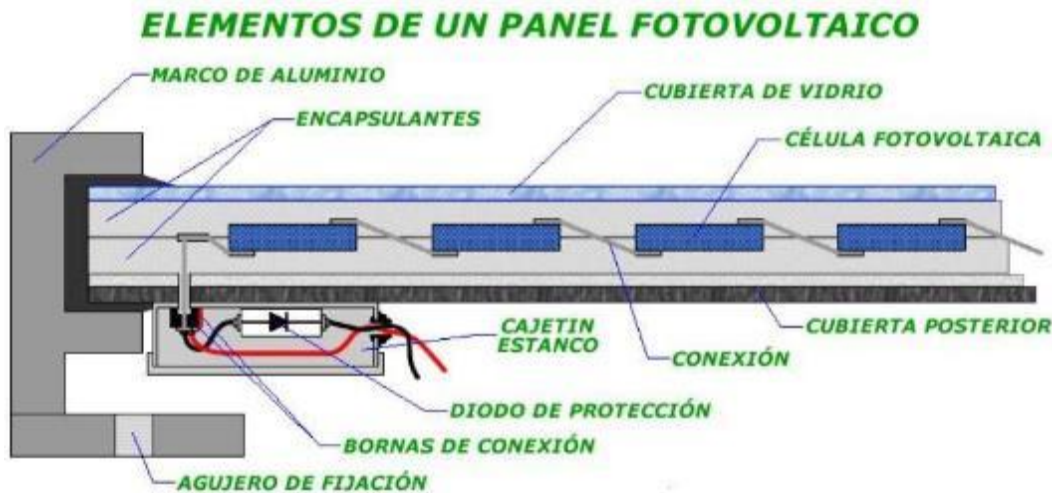
Figura 34: Elementos de un panel fotovoltaico
