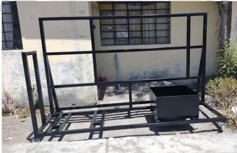
Figura 57. Estructura del banco de tuberías
