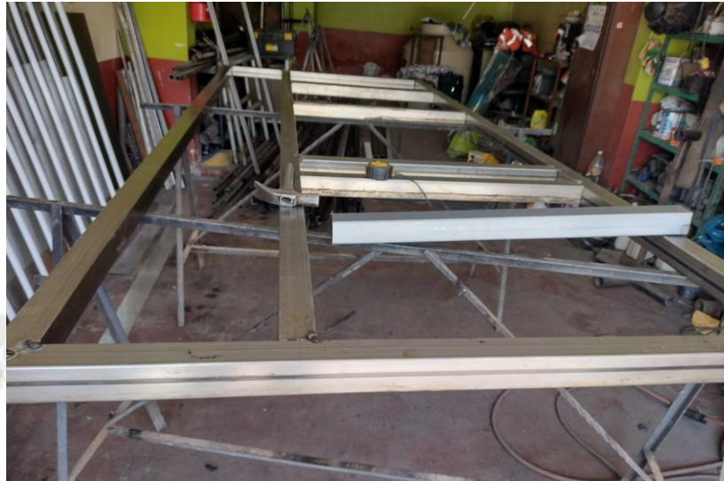
Figura 56. Elaboración de la estructura del banco de tuberías
