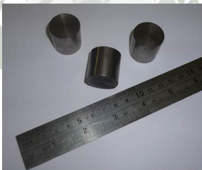
Fig. N° 3.6 Probetas utilizadas para el ensayo de metalografía.
