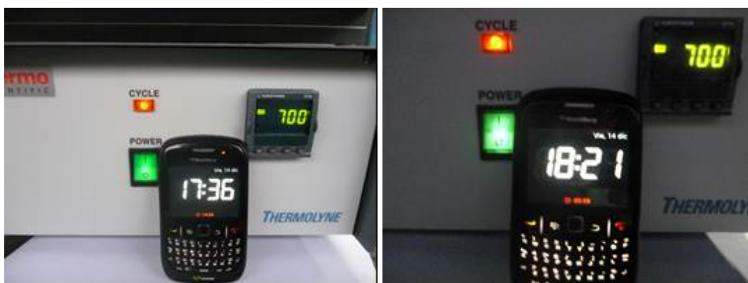
Fig. N° 3.2 Tiempo de duración del recocido de baja temperatura (45 min).
