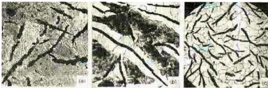
a) Fundición perlítica, tomada a 200 aumentos; b) Fundición ferrito - perlítica, tomada a 100 aumentos; c) Fundición ferrítica, tomada a 100 aumentos.
