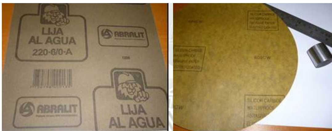
Fig. N° 3.8 Tipos de papeles abrasivos utilizados para el desbaste fino.
