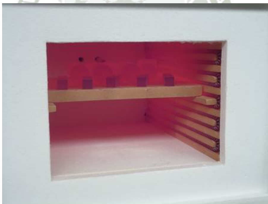
Fig. N° 3.3 Probetas despues del recocido de baja temperatura.
