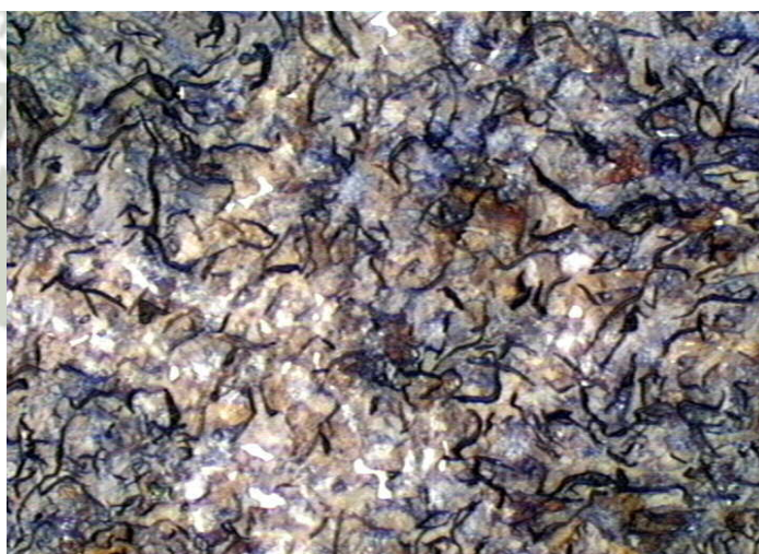
Fig. N° 2.2 Fundición Gris en bruto tomada a 100 aumentos. Fuente: http://www.esi2.us.es/IMM2/Pract-html/y2.html
