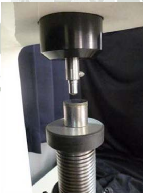
Fig. N° 3.21. Probeta lista para realizar el ensayo de dureza.
