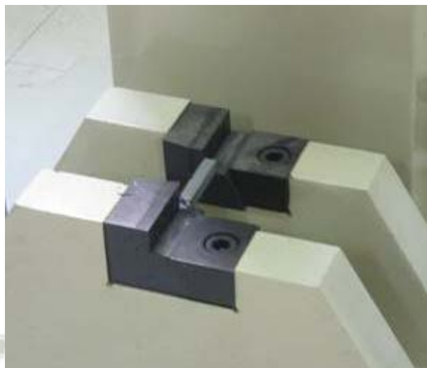
Fig. N° 3.23 Probeta para el ensayo de resiliencia.
