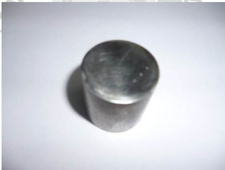
Fig. N° 3.10 Superficie de la probeta despues del desbaste fino.
