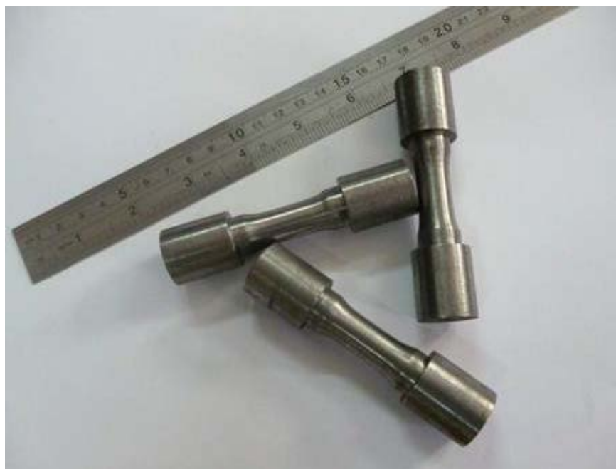
Fig. N° 3.18 Probetas para el ensayo de tracción.
