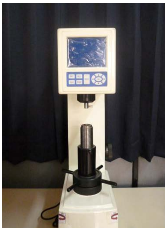
Fig. N° 3.20. Maquina utilizada para el ensayo de dureza.
