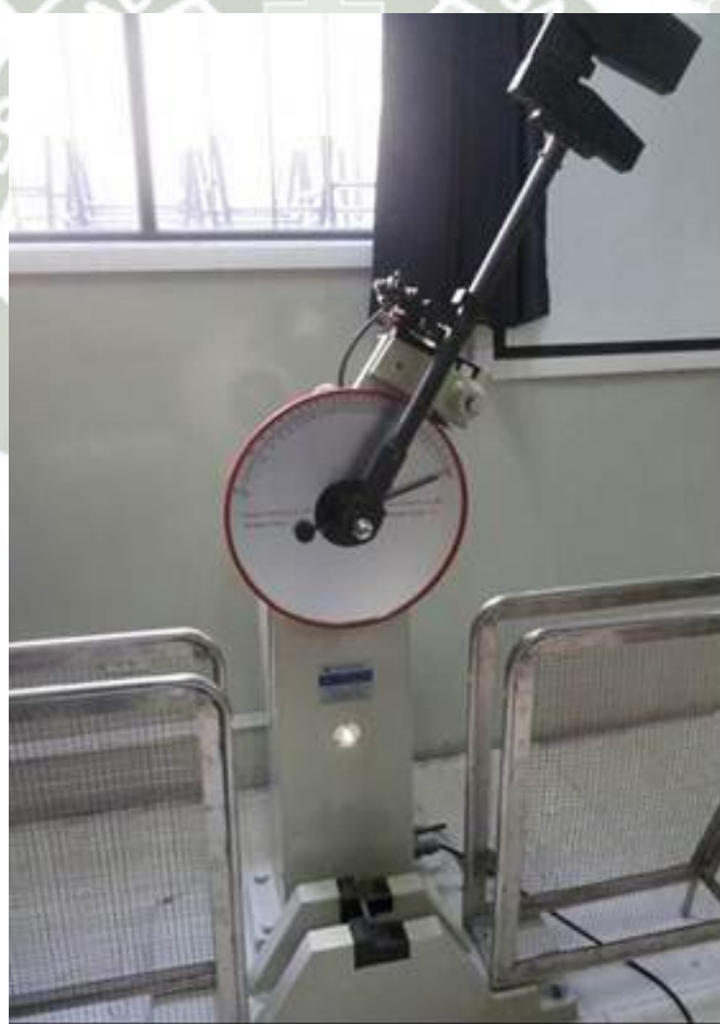
Fig. N° 3.24 Probeta lista para el ensayo de resiliencia.
