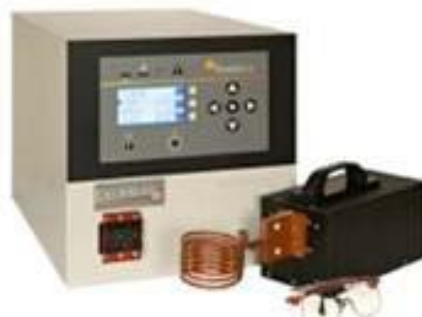
Fig. N° 2.10 Horno de inducción eléctrica
