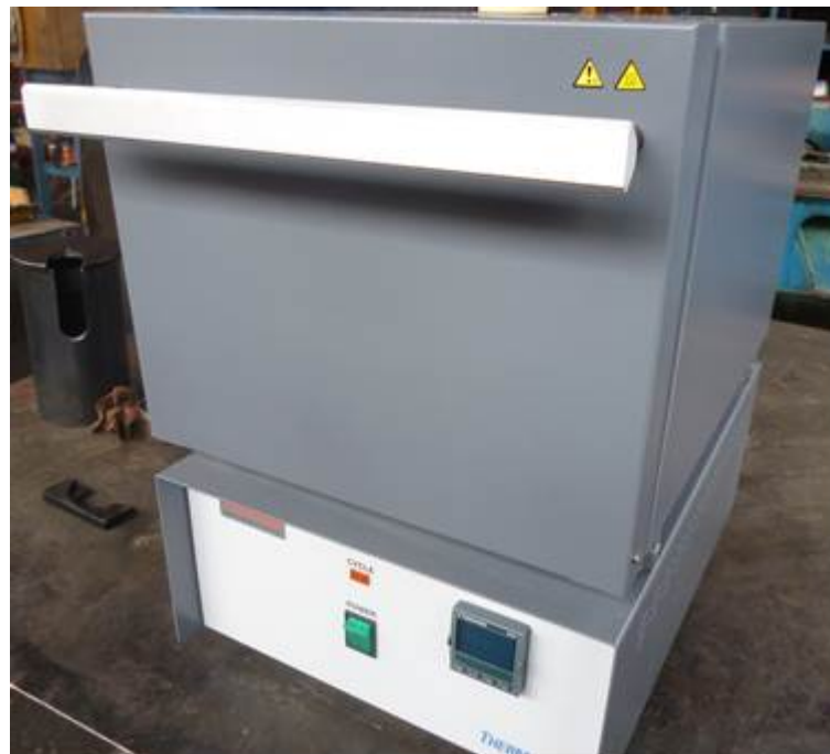
Fig. N° 3.1 Horno para realizar los tratamientos termicos en las probetas.
