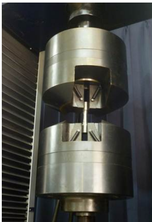
Fig. N° 3.19 Probeta montada en las mordazas de la maquina universal de ensayos.
