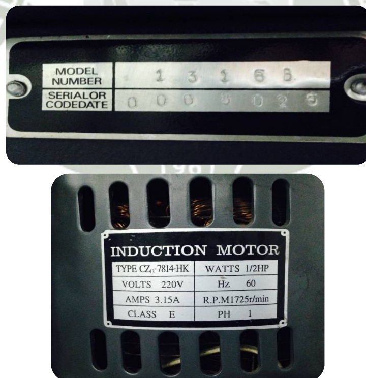
FIGURA # 041.- Modelo y serie de taladro de columna 1316B
