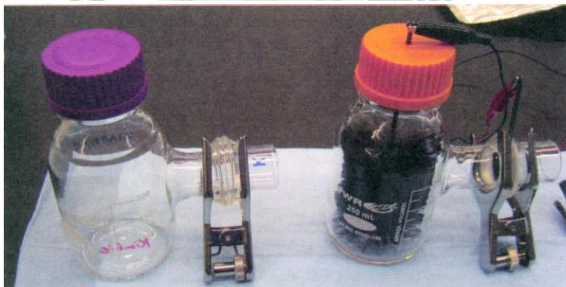
Figura 7. Reactor uni-cámara, cátodo aire con brazo lateral.
