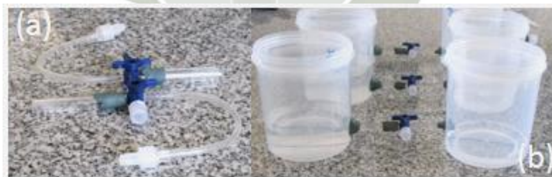
Figura 20. Lazo electrolítico diseñado para ML-MFC.
