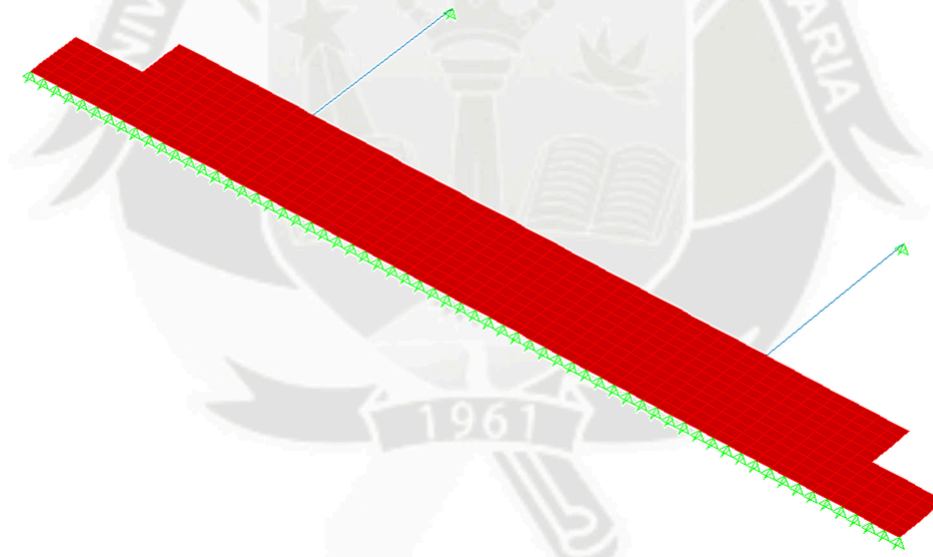
Figura 5.38 Modelo utilizado para el diseño de la zapata conectada
