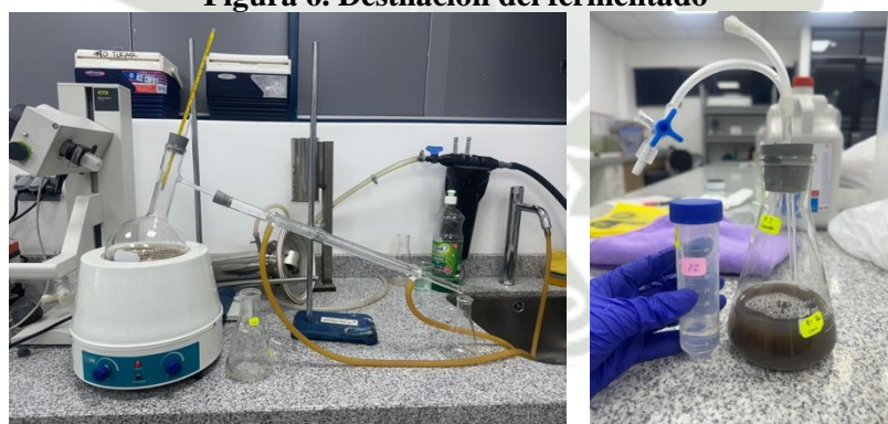
Figura 6. Destilación del fermentado
