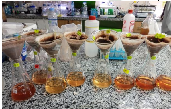
Figura 3. Obtención del hidrolizado de la biomasa pretratada
