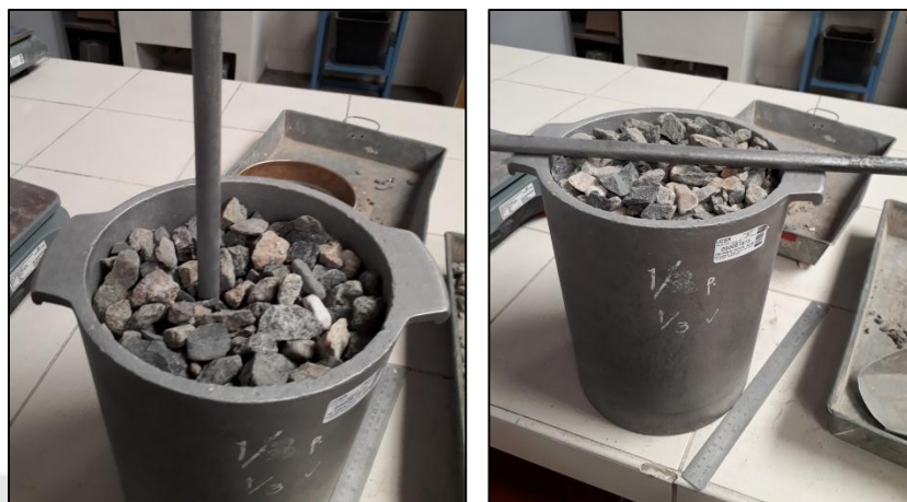
Ilustración 4.14. Prueba de Peso unitario compactado del Agregado Grueso
