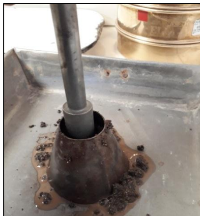
Ilustración 4.6. Prueba de Absorción del Agregado Fino
