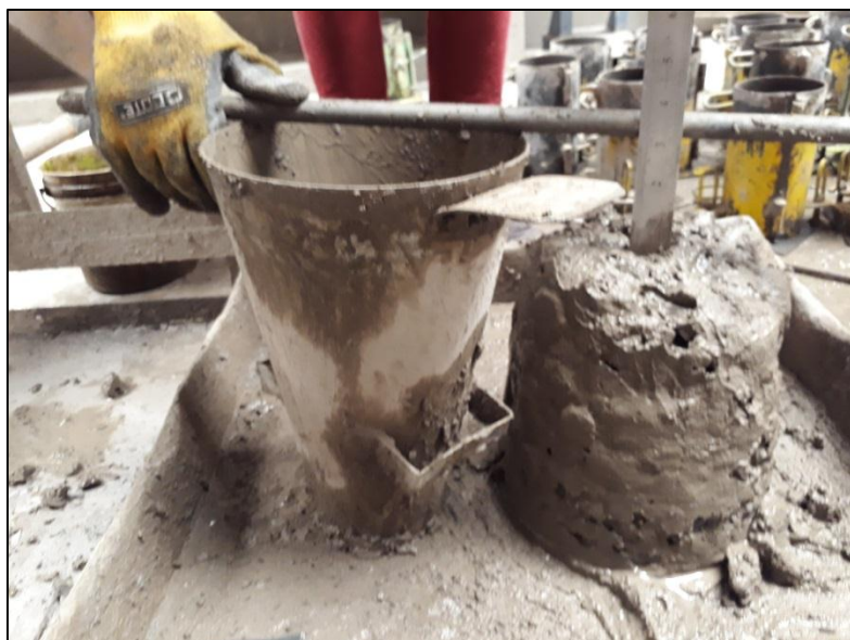
Ilustración 5.1. Ensayo de Asentamiento del concreto en estado fresco
