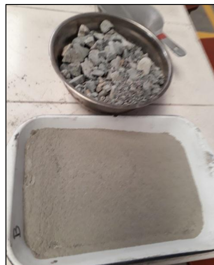
Ilustración 4.18. Prueba de Abrasión – Agregado Grueso
