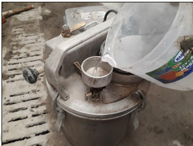
Ilustración 5.3. Ensayo de Contenido de aire del concreto en estado fresco
