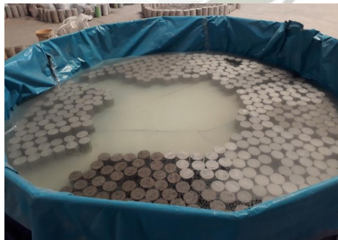
Ilustración 5.5. Pozo de curado
