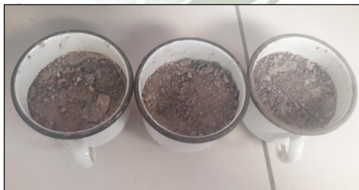
Ilustración 4.15. Prueba de Cantidad de Finos que pasan la Malla #200 - Agregado Fino
