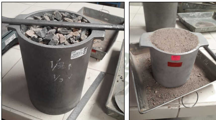
Ilustración 4.12. Prueba de Peso unitario suelto del Agregado Fino y Grueso
