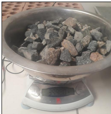
Ilustración 4.16. Prueba de Cantidad de Finos que pasan la Malla #200 - Agregado Grueso
