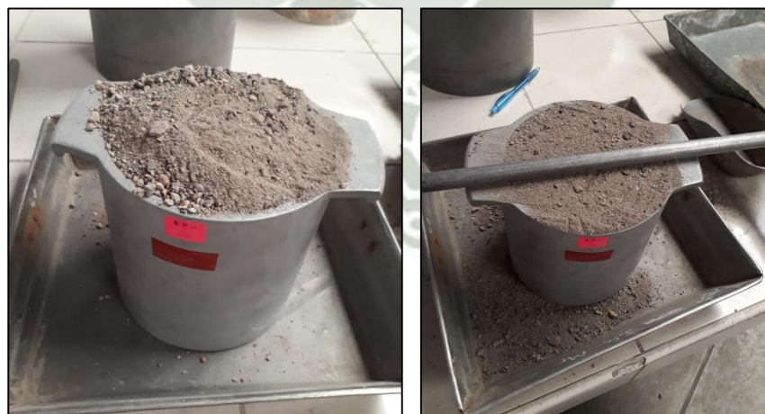
Ilustración 4.13. Prueba de Peso unitario compactado del Agregado Fino
