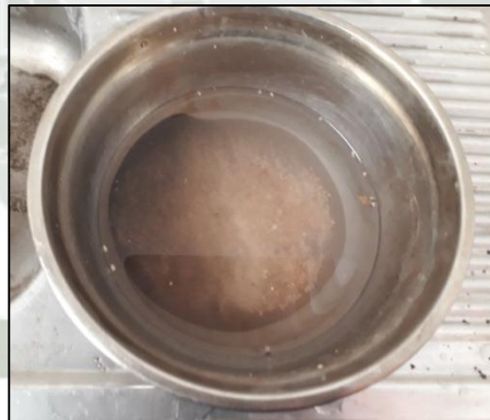
Ilustración 4.5. Agregado Fino reposando en agua por 24 horas
