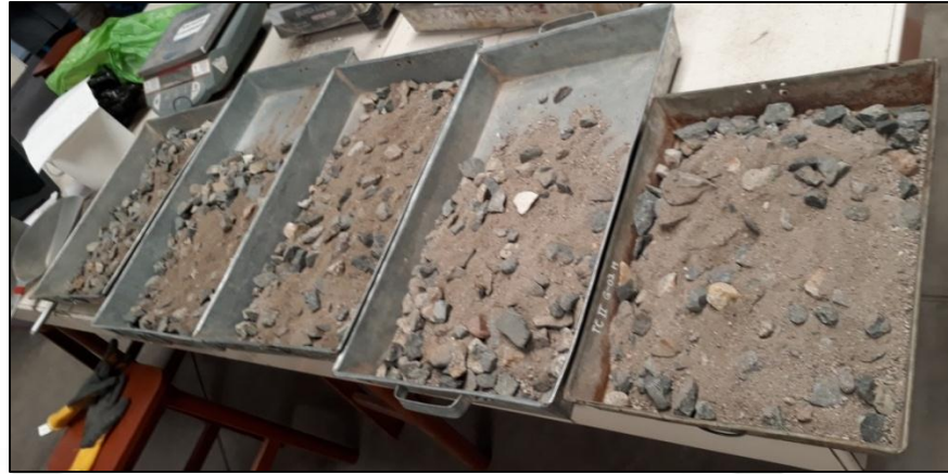
Ilustración 4.21. Ensayo de Peso Unitario de la Combinación de los agregados
