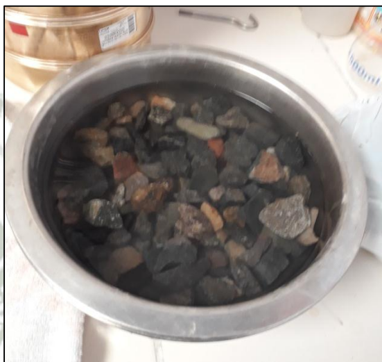
Ilustración 4.9. Agregado Grueso reposando en agua 24 horas
