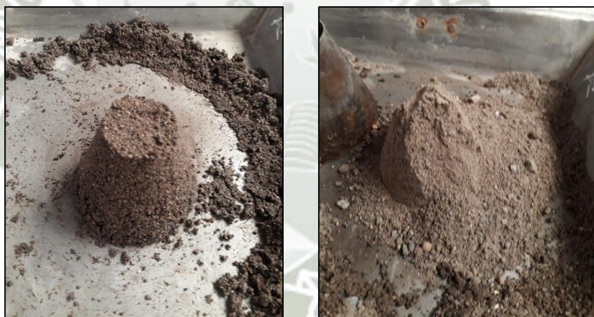
Ilustración 4.7. Prueba de Absorción del Agregado Fino en condición saturada superficialmente seca
