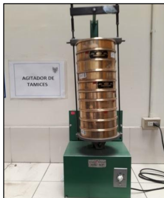
Ilustración 4.1. Agitador de Tamices – Granulometría Agregado Fino
