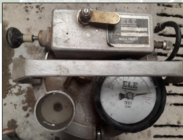
Ilustración 5.4. Ensayo de Contenido de aire del concreto en estado fresco
