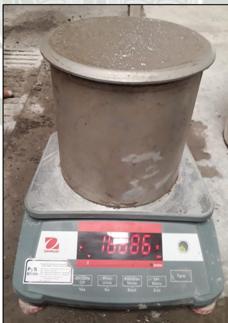
Ilustración 5.2. Ensayo de Peso Unitario del concreto en estado fresco
