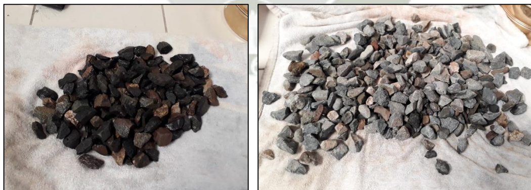
Ilustración 4.10. Agregado Grueso en estado saturado y estado saturado superficialmente seco
