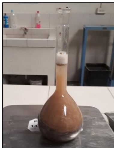
Ilustración 4.8. Ensayo de Peso específico del Agregado Fino
