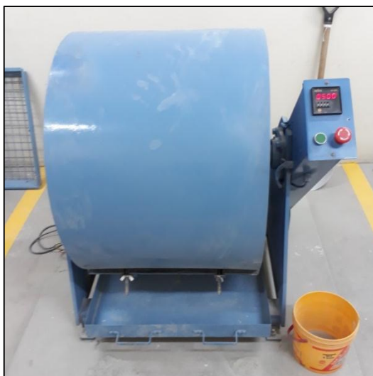
Ilustración 4.17. Máquina de abrasión de los Ángeles
