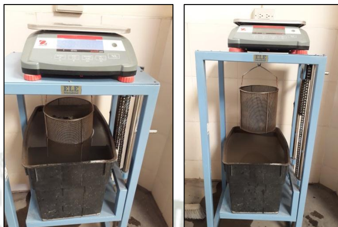
Ilustración 4.11. Prueba de ensayo de peso específico del Agregado Grueso
