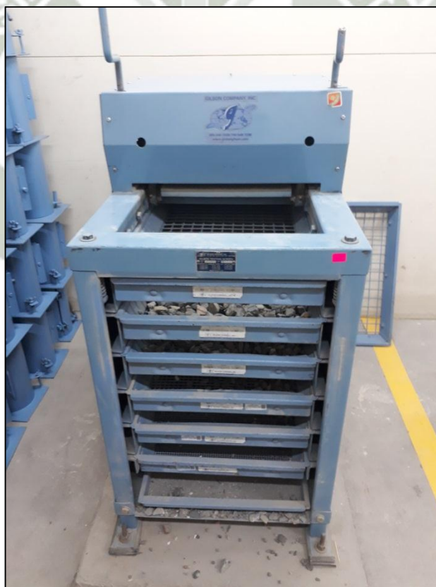
Ilustración 4.3. Agitador de Tamices – Granulometría Agregado Grueso
