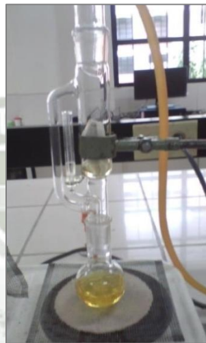
Fig. 18 Extracción con Soxhlet del rizoma de Zingiber officinale Roscoe “jengibre” Fuente: Elaboración propia
