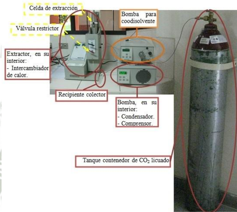
Fig. 5 Partes de un equipo de extracción con fluido supercrítico sin recirculación del disolvente
