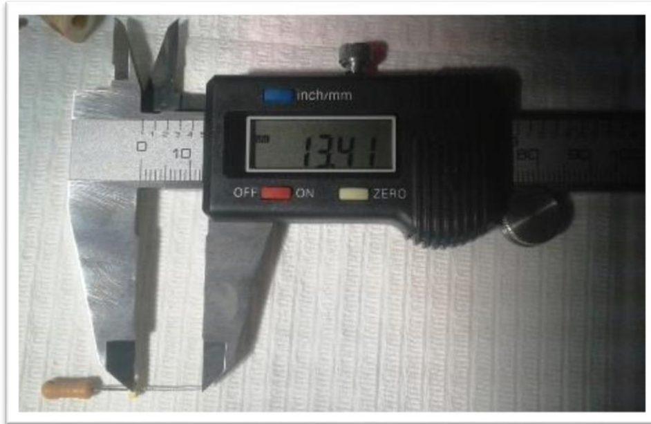
Figura 6: Medición de las longitudes con el Caliper Digital “Vernier Pie de Rey”.
