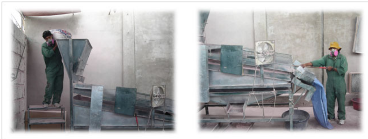
Fotografía 6. Zaranda eléctrica con mallas múltiples y diferentes salidas que permite la óptima limpieza del producto así como la clasificación de la cochinilla, separando la cochinilla de primera calidad, cochinilla de segunda y polvo
