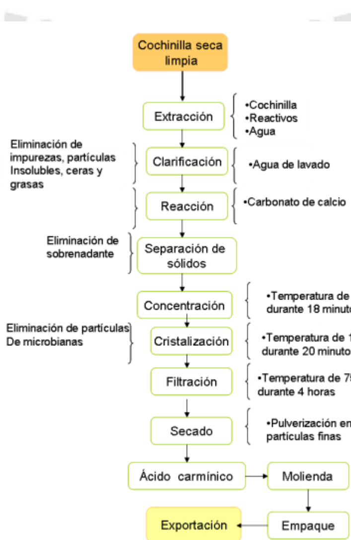
Flujograma 2: Proceso de extracción de ácido carmínico a partir de cochinilla seca
