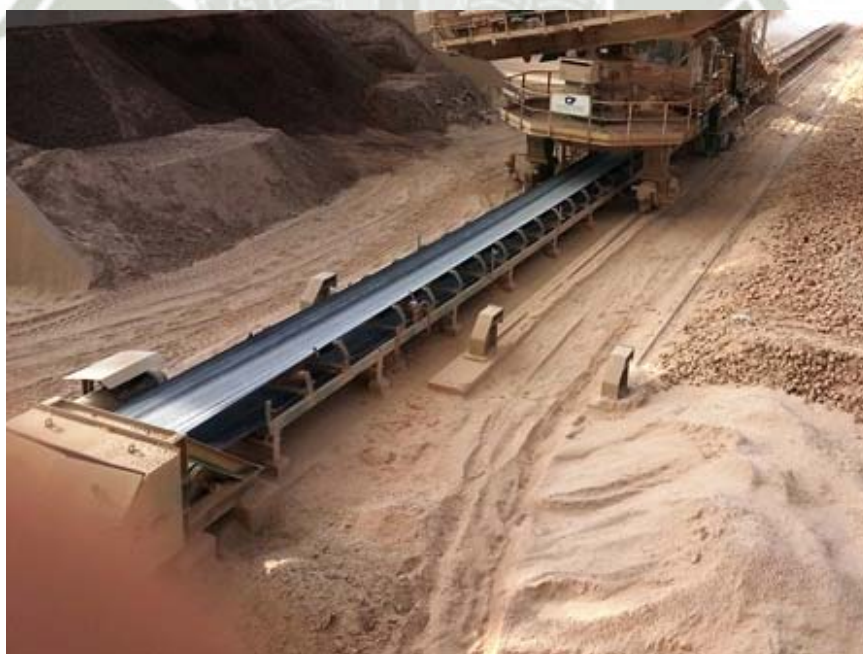
Imagen A8: Faja transportadora de caliza, lado tambor motriz
