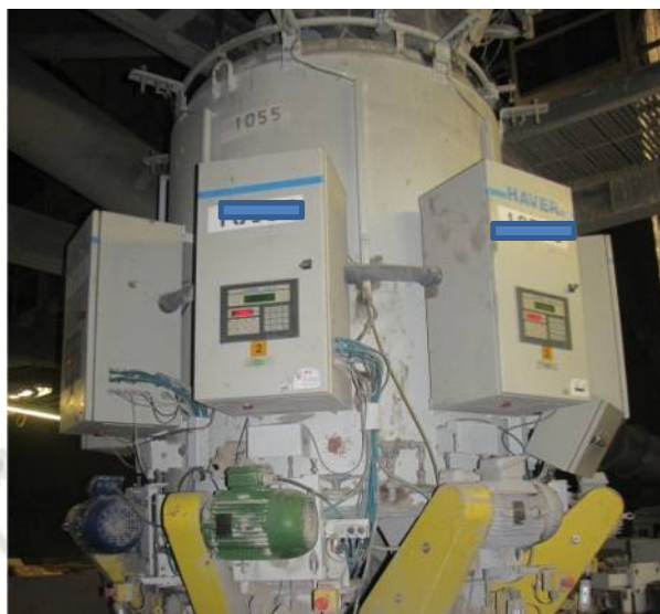
Imagen A7: Ensacadora rotativa de 12 pistones
