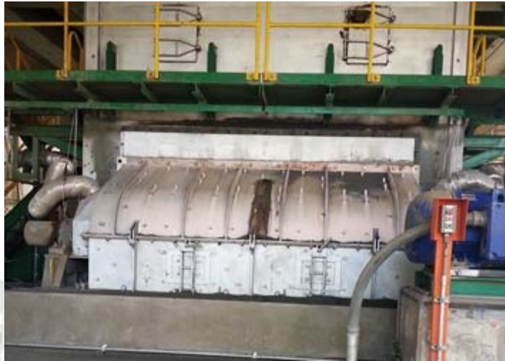
Imagen A3: Vista frontal de la chancadora de clinker en trabajo
