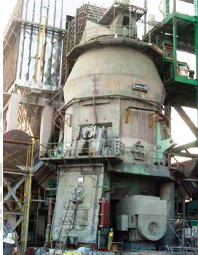
Imagen A10: Molino vertical de cemento con accionamiento y filtro
