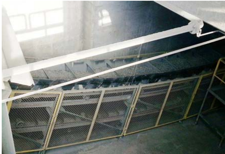
Imagen A13: Transportador de clinker con carga
