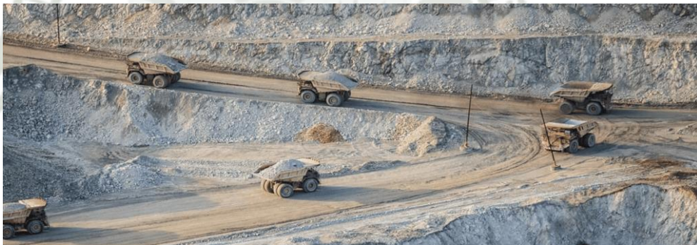
Figura 7. Configuración de rampas en Zig Zag de la unidad minera
