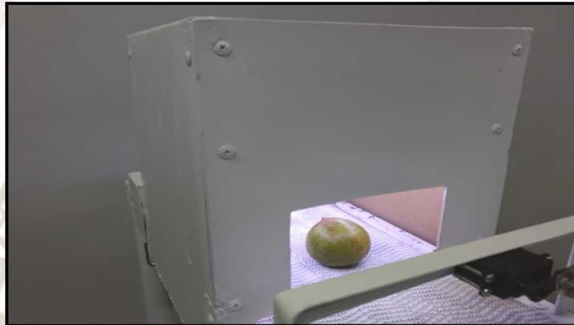
Figura 34. Módulo de captura implementado
