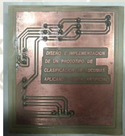
Figura 33. Circuito impreso elaborado
