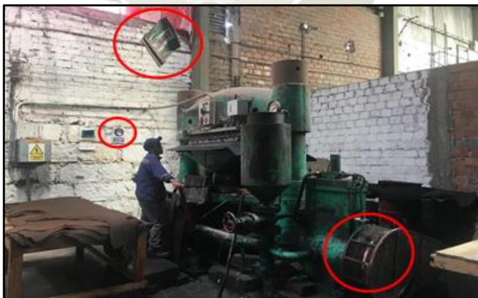
Figura 16: Falta de correcta señalización
