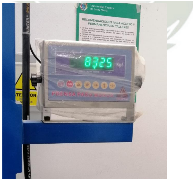
Foto 52 Ensayo de Compresión Diagonal de Murete Patrón - 6 Con Cemento Frontera Tipo IP
