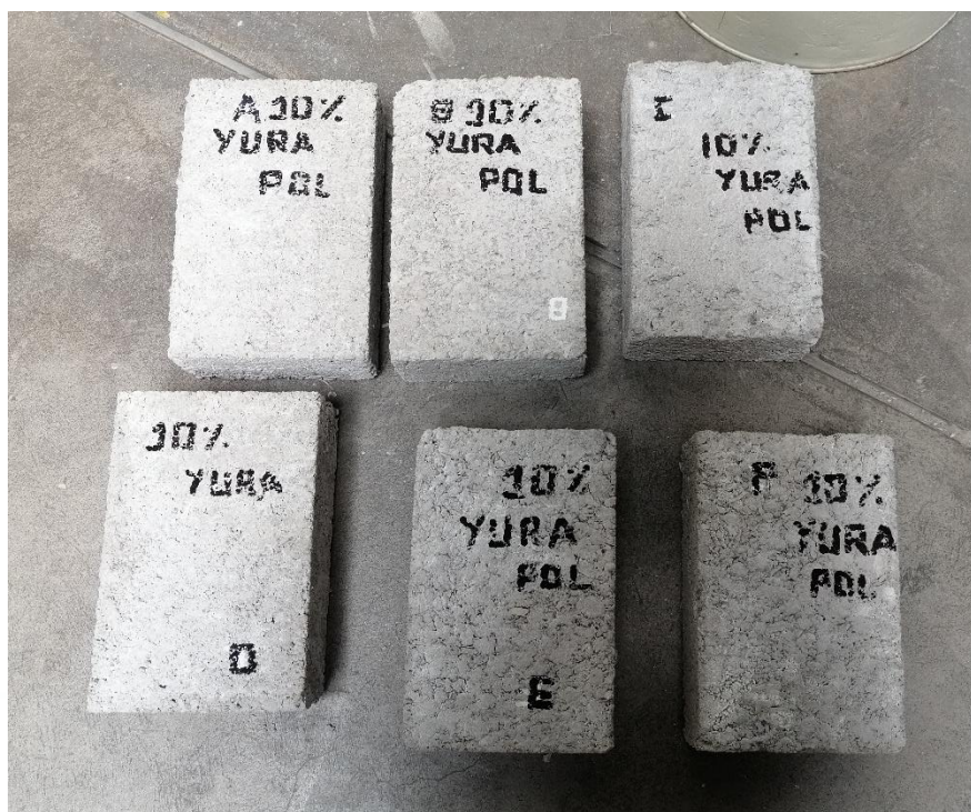
Foto 34 Ladrillos Adicionados con 10 % de Viruta de Poliamida por Sustitución de Arena Gruesa
