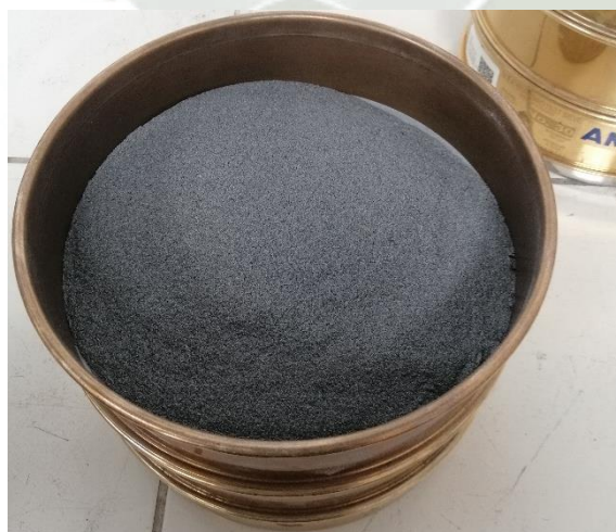
Foto 21 Ensayo de Granulometría de la Ceniza de Cascarilla de Arroz
