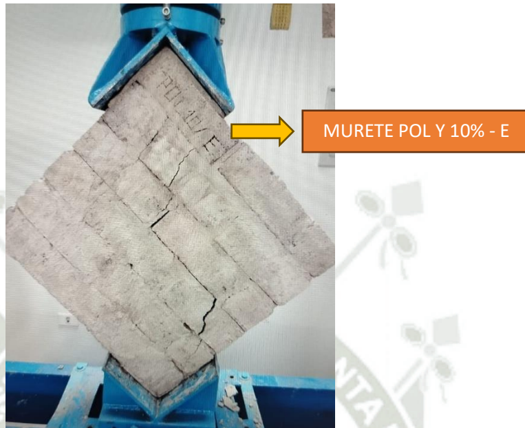
Foto 36 Falla Por Mortero y a la Unidad con Ladrillos adicionados con 10 % de Viruta de Poliamida (POL-Y 10%)
