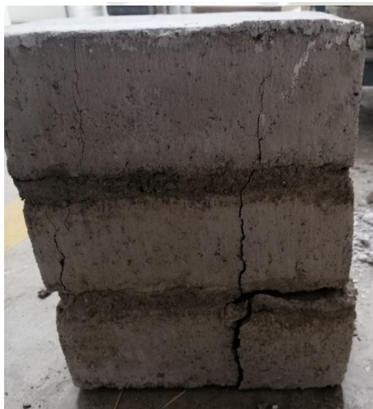
Foto 44 Falla de Separación del frente Superficial del Lado B del Prisma Patrón con Cemento Yura IP
