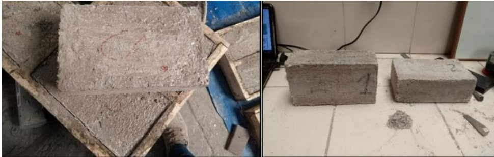
Figura 6 Proceso de Elaboración de Unidades de Albañilería con PETS en los Laboratorios de la UCSM
