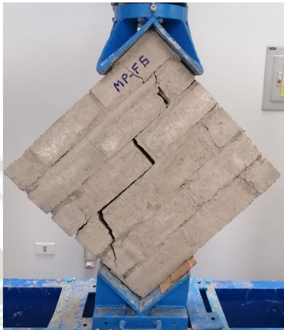
Foto 51 Resistencia a Compresión Diagonal de Murete Patrón
