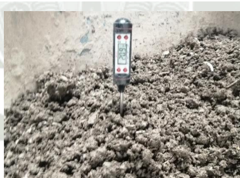
Foto 25 Toma de Temperatura de la Mezcla
