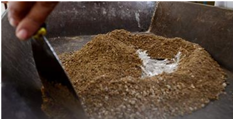
Figura 5 Adición de Fibras de PETS en la preparación de Mortero
