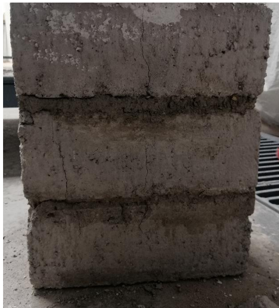
Foto 48 Falla por Separación Superficial del Lado B del Prisma Patrón con Cemento Frontera Tipo IP.
