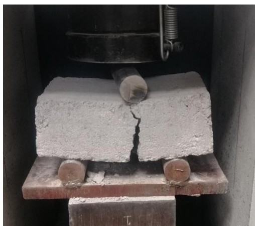
Foto 37 Ensayo de Resistencia a la Flexión por Tracción de los Ladrillos Patrón
