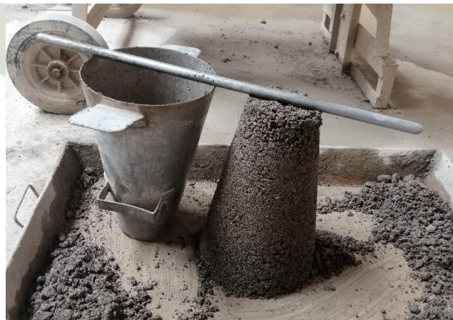
Foto 24 Ensayo del Cono de Abrams para medir el Asentamiento (SLUMP “0”)
