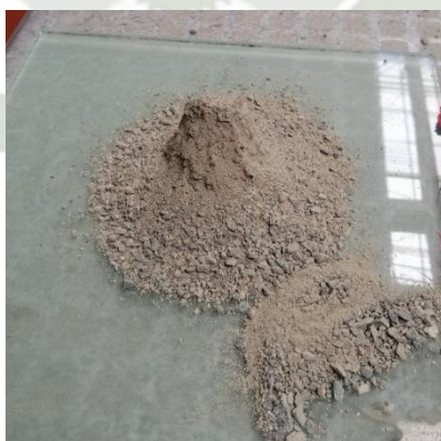
Foto 4 Arena Gruesa en Estado Superficialmente Seco
