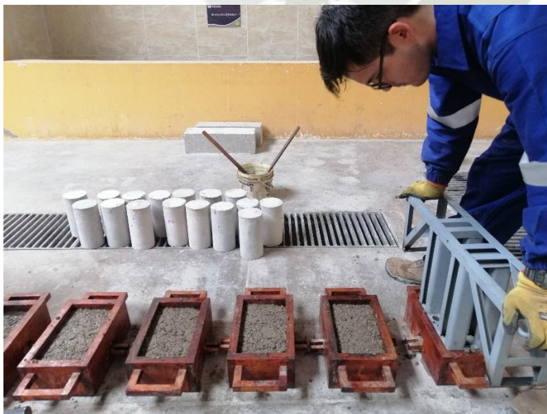
Foto 40 Compactado de la Mezcla para Ladrillos
