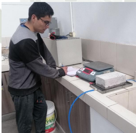
Foto 31 Ensayo de Succión de los Ladrillos
