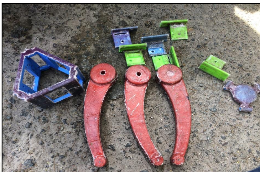
Figura 4.10. Piezas del robot paralelo delta reforzadas con fibra de vidrio
