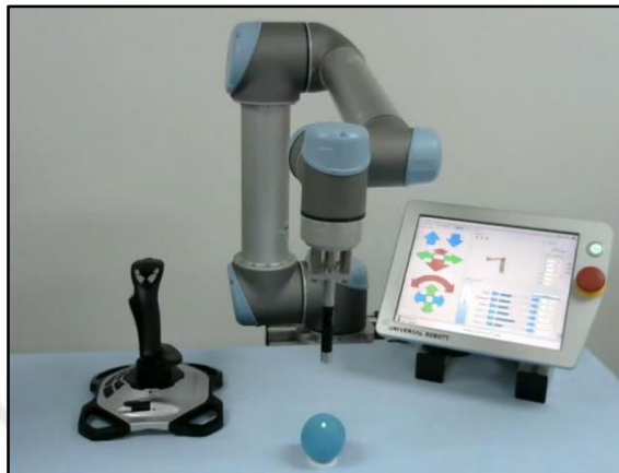
Figura 3.4. Manipulador Robótico con Interfaz Humano Maquina y Joystick Fuente: (Zacobria, 2018)
