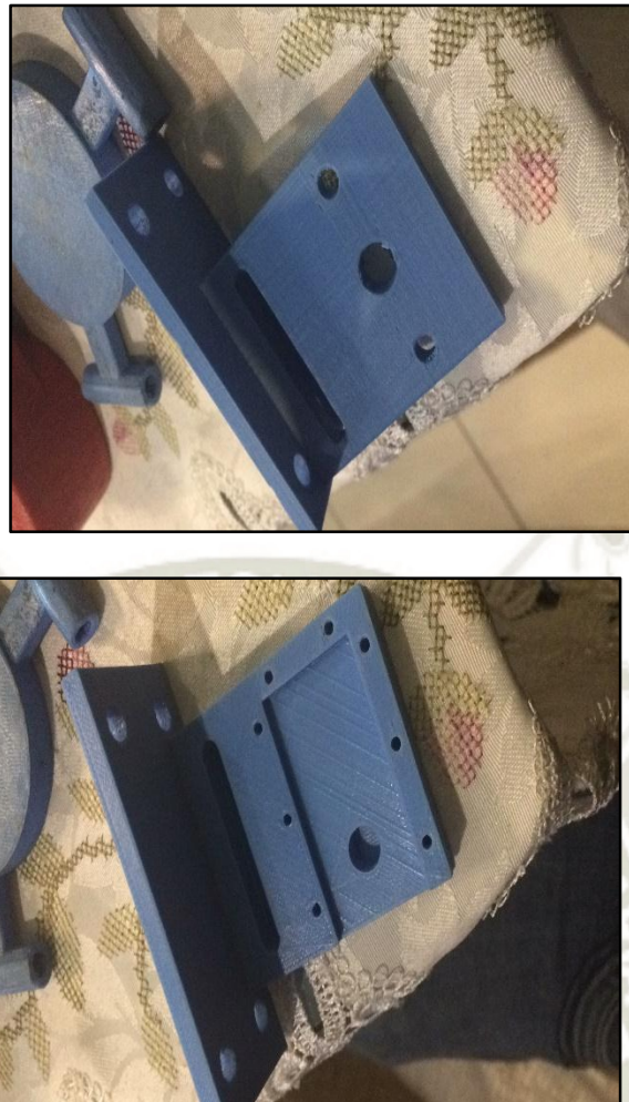
Figura 4.8. Base de la chumacera y base del servomotor Fuente: Elaboración propia.
