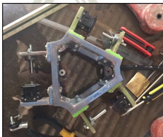
Figura 4.12. Ensamble preliminar de la base fija, base del servomotor y base chumacera
