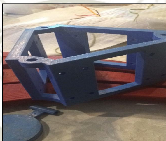
Figura 4.7. Brazos, base móvil y base fija impresos Fuente: Elaboración propia.
