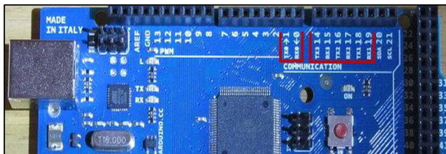
Figura 3.63. Puertos de comunicación serial del Arduino MEGA
