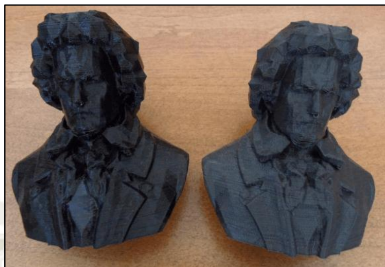
Figura 3.21. Impresión 3D PLA (izquierda) - Impresión 3D ABS (derecha) Fuente: (Delta3D, 2017)
