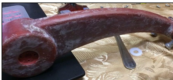
Figura 4.11. Brazo recubierto con fibra de vidrio y Gel - Coat
