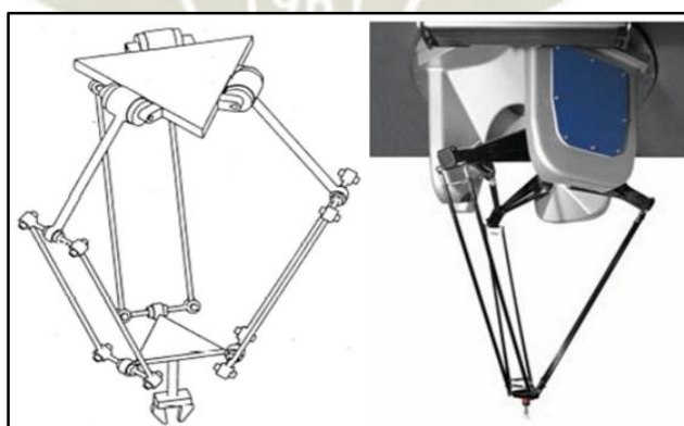
Figura 1.1. Estructura Delta propuesta por Clavel y su versión industrial
