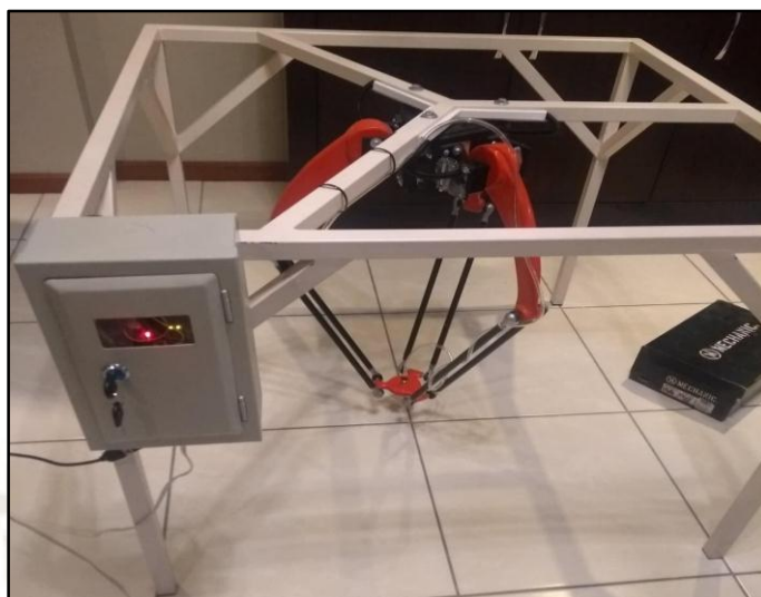
Figura 6.16. Robot paralelo delta implementado con tablero de control
