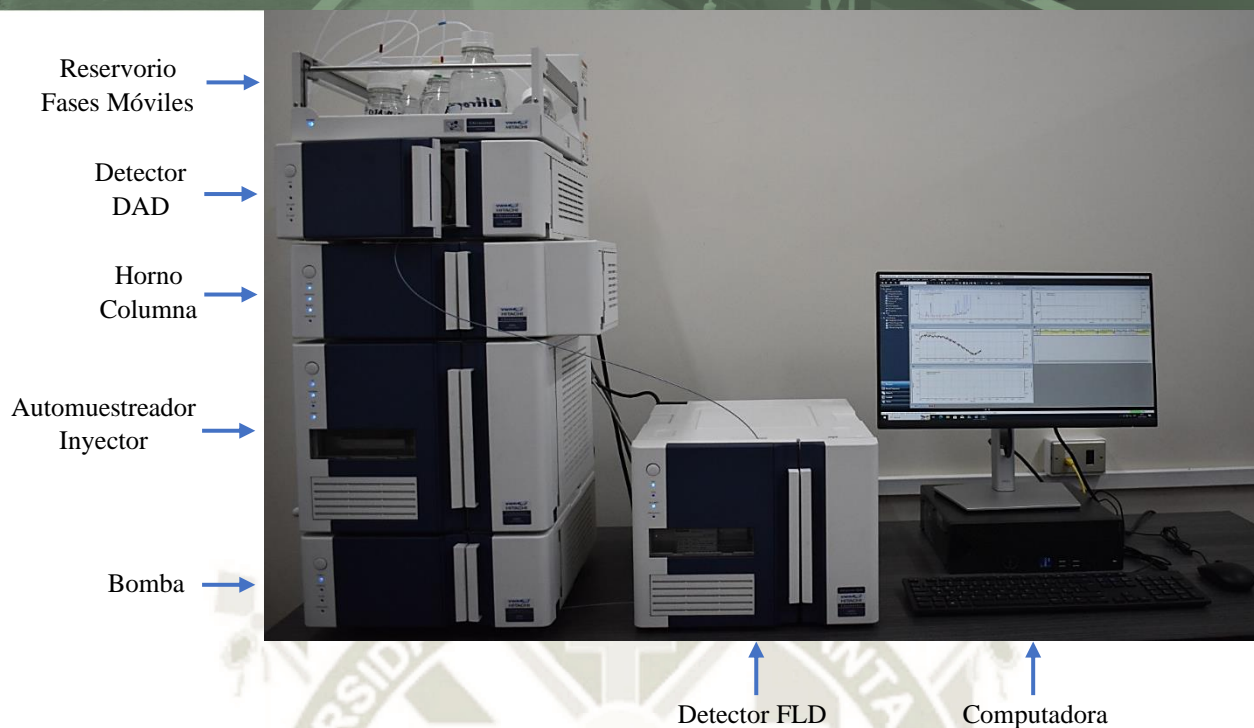
Figura 4. Equipo HPLC Hitachi. Elaboración Propia
