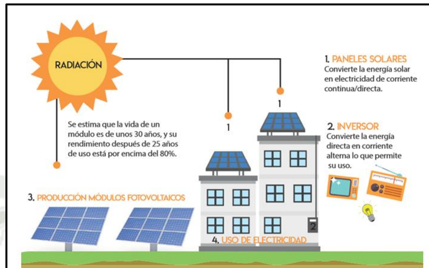
Figura 22: Transformación de Energía Fotovoltaica
