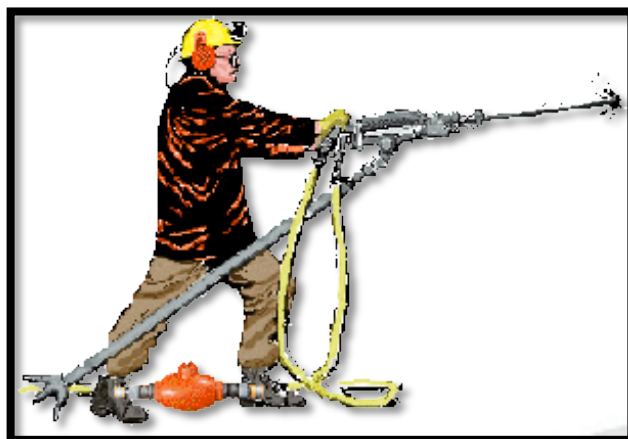
Ilustración 3-10 Perforación con Jackleg
