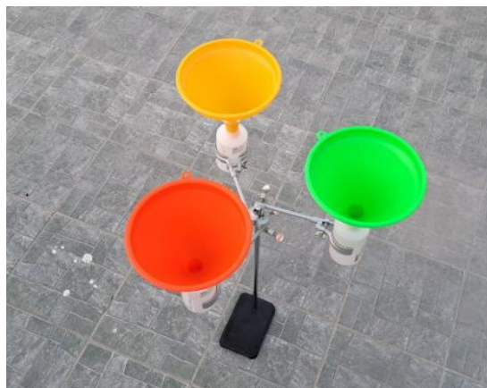
Figura 16 Colector de agua de lluvia
