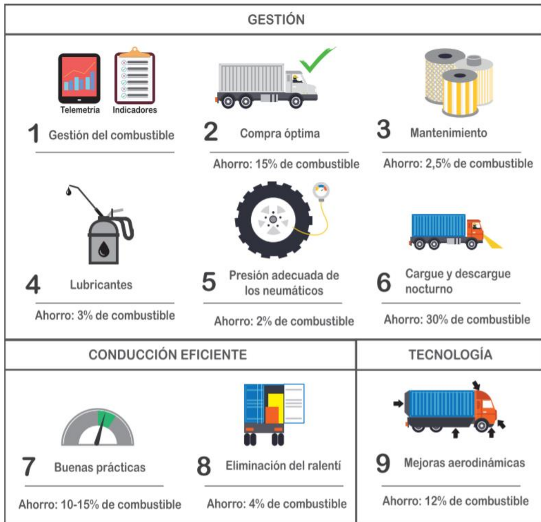
Figura 4 – Reducción de consumo de combustible para la eficiencia de transporte Fuente – LEDS LAC Elaborado en base a datos de la agencia de eficiencia energética de Chile y estudio de Rodríguez, Cruz, Estevez y Vasano. (2003)
