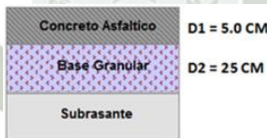
Ilustración 33 Paquete Estructural Tramo N°02
