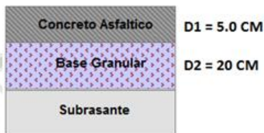
Ilustración 32 Paquete Estructural Tramo N°01
