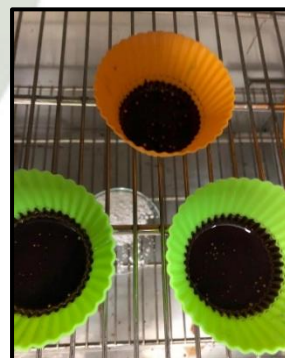
Figura 22. Secado de partículas en estufa a 40°C.
