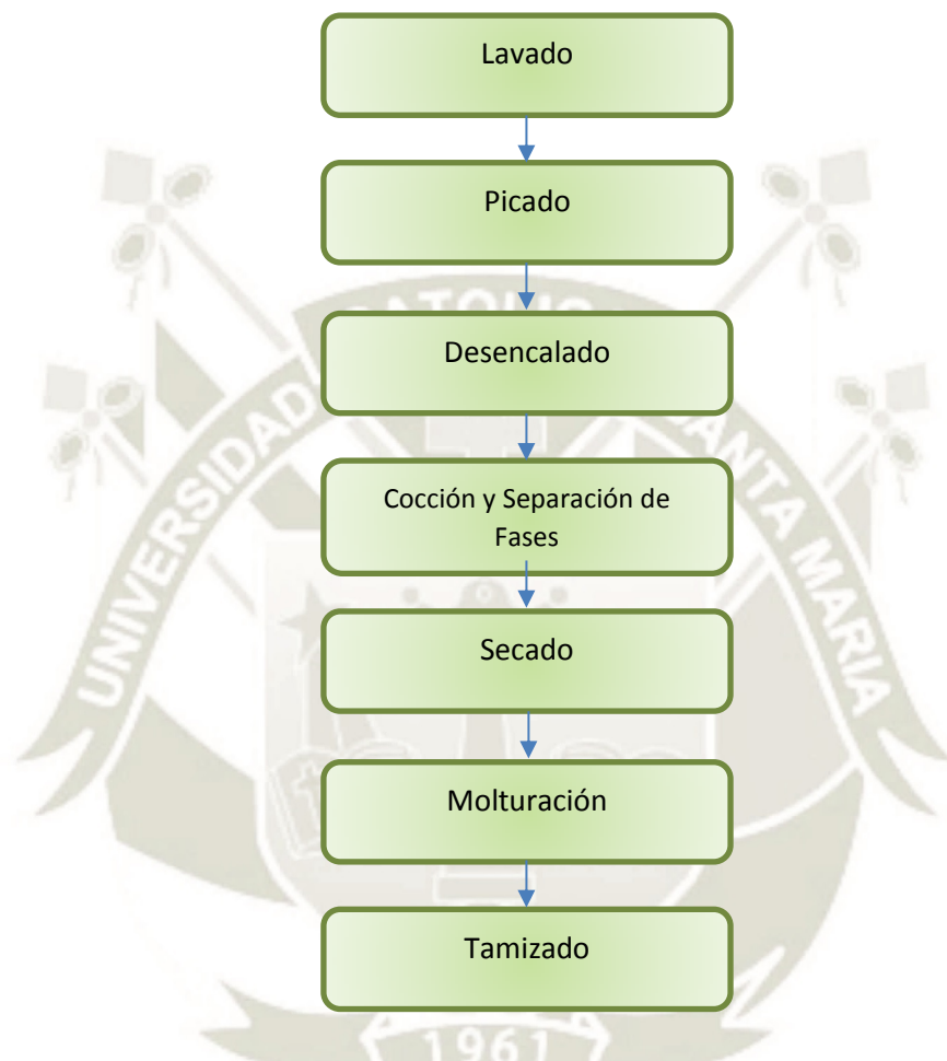
Ilustración 22: Diagrama de Flujo de Proceso.
