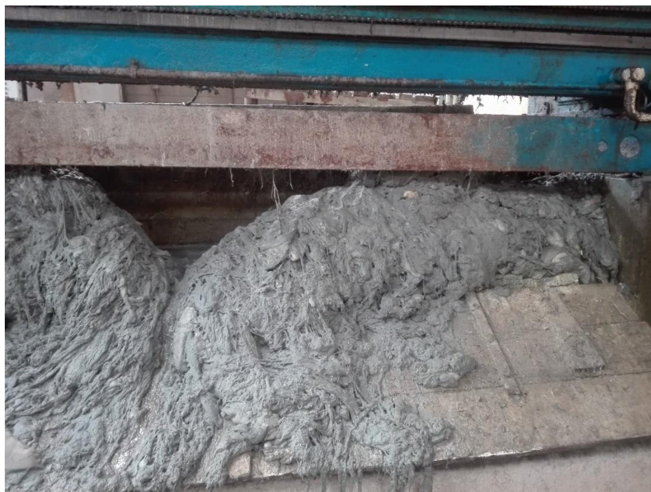
Ilustración 9: Descarne tecnificado (máquina) con textura pastosa.
