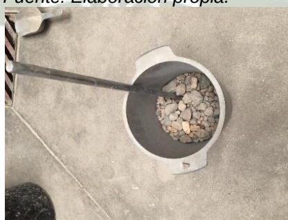
Figura 2.31. Olla + Agregado Grueso, hallando el peso suelto de la muestra.
