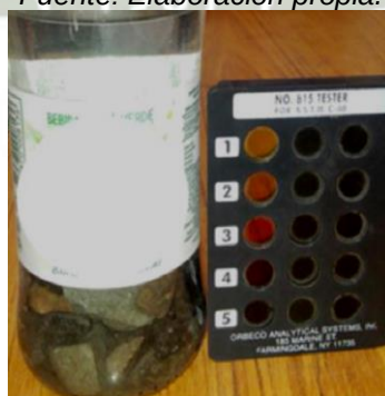
Figura 2.49. Comparación de muestra con la tabla de colores – Agregado grueso de Rio.
