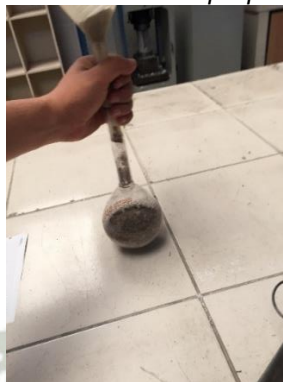
Figura 2.40. Prueba de fiola, introducción y agitado – Agregado fino de Río.
