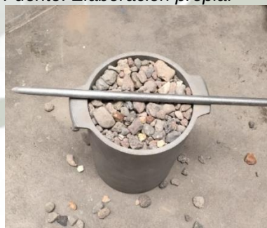
Figura 2.48. Olla + Agregado Grueso, hallando el peso suelto de la muestra.
