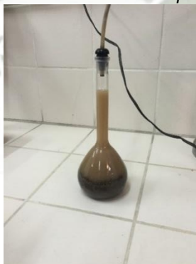
Figura 2.41. Eliminación de espacios vacíos, extracción de aire – Agregado fino de Río.
