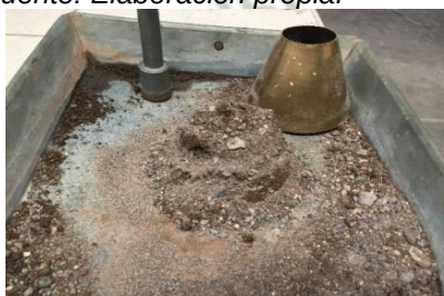
Figura 2.39. Prueba de cono, retirado de molde cónico – Agregado fino de Rio.
