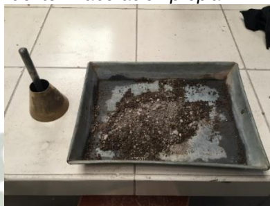
Figura 2.38. Prueba de cono apisonado – agregado fino de Rio.
