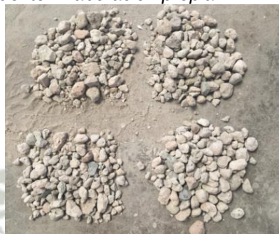
Figura 2.30. Cuarteo del agregado grueso – Filtro.
