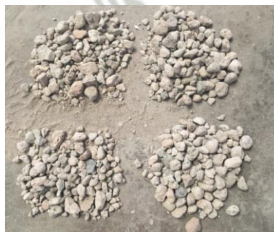
Figura 2.35. Cuarteo de la muestra de agregado grueso - Filtro.
