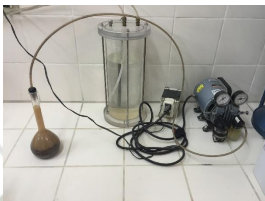
Figura 2.22. Eliminación de espacios vacíos, extracción de aire – Over Liner.
