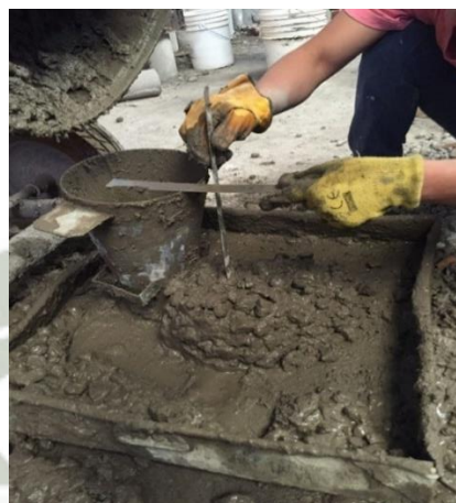
Figura 2.52. Utilizando el cono de Abrams, Hallamos el Slump.
