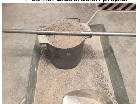
Figura 2.23. Rebosamiento el Agregado Fino – Over Liner.
