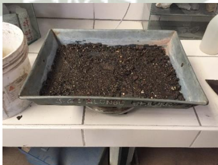
Figura 2.18. Muestra en estufa, para obtener una humedad uniforme – agregado over Liner.
