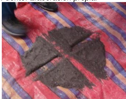
Figura 2.36. Cuarteo de muestra - agregado fino de Rio.
