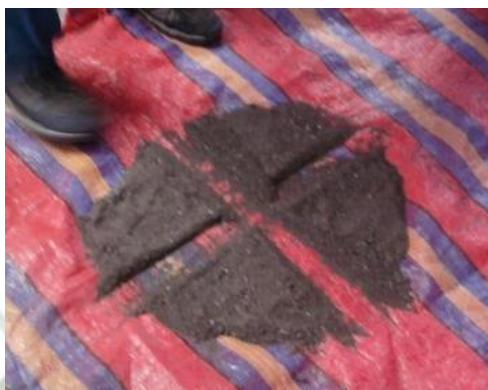
Figura 2.17. Cuarteo de muestra - agregado Over Liner.
