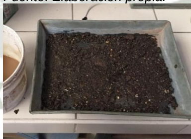
Figura 2.37. Muestra en estufa para obtener una humedad uniforme – Agregado fino de Rio.
