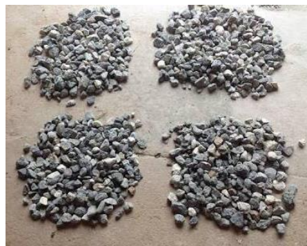
Figura 2.51. Cuarteo de la muestra de agregado grueso - Río.
