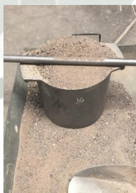
Figura 2.42. Rebosamiento el Agregado Fino - Rio.
