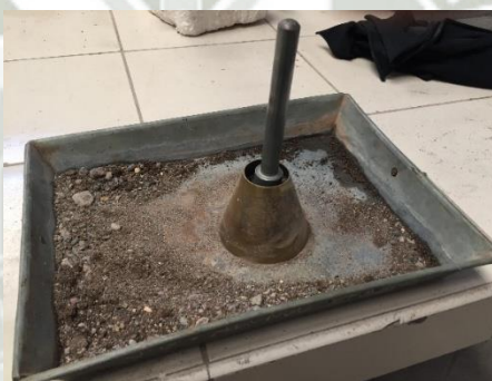
Figura 2.19. Prueba de cono apisonado – over Liner.
