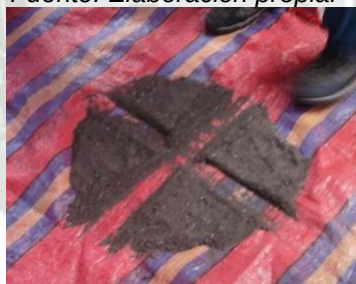
Figura 2.44. Proceso de cuarteo de la muestra de agregado Fino – Agregado fino de Río.
