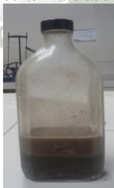
Figura 2.41. Procedimiento de ensayo para la obtención de impurezas orgánicas – Agredo fino de Rio.
