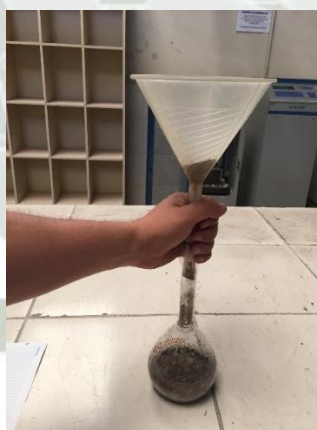
Figura 2.21. Prueba de fiola, introducción y agitado – over Liner.
