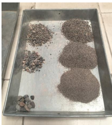
Figura 2.46. Muestreo de material retenido en los diferentes tamices del agregado fino – Rio.
