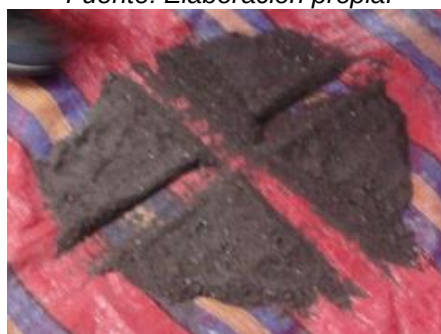
Figura 2.27. Proceso de cuarteo de la muestra de agregado Fino – Over Liner
