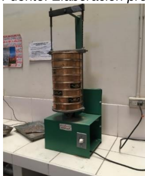
Figura 2.28. Colocación de la muestra en la maquina tamizadora al rededor 3 min.
