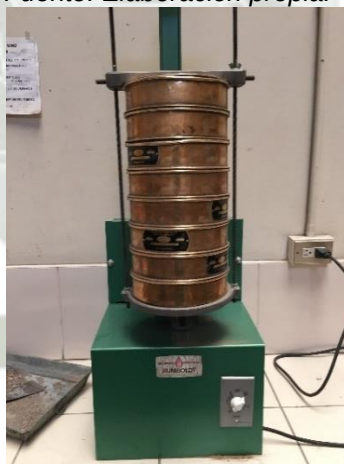
Figura 2.45. Colocación de la muestra en la maquina tamizadora al rededor 3 min.
