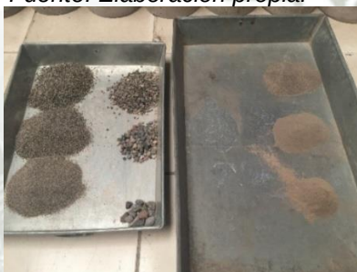
Figura 2.29. Muestreo de material retenido en los diferentes tamices del agregado fino – Over Liner.
