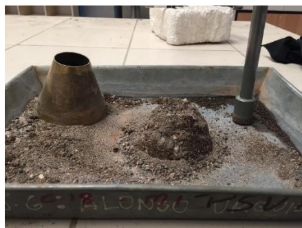
Figura 2.20. Prueba de cono, retirado de molde cónico – over Liner.
