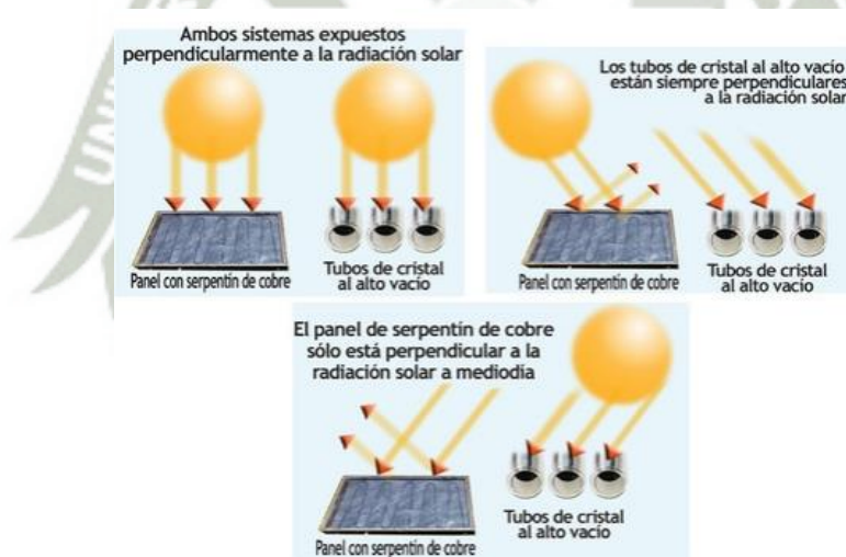
Figura 2.37 Disposición de tubos de vacío perpendiculares al sol.
