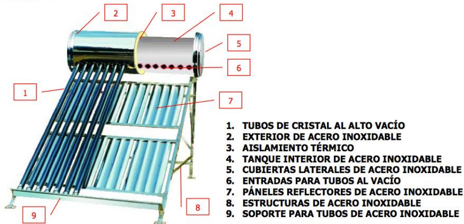
Figura 2.34 Disposición de tubos de vacío.
