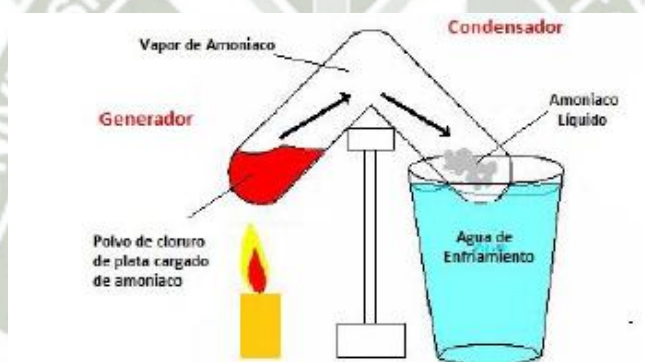
Figura 2.4 Desorción y condensación de amoníaco a alta temperatura
