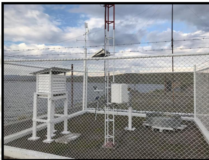
Figura 33. Estación meteorológica el Pañe. Instrumentos: Pluviómetro, evaporímetro y caseta.
