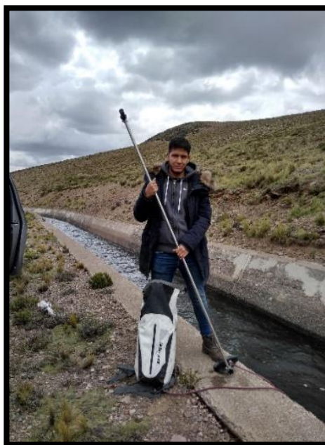
Figura 102. Componentes del sistema AquaProfilor para la medición de caudales.
