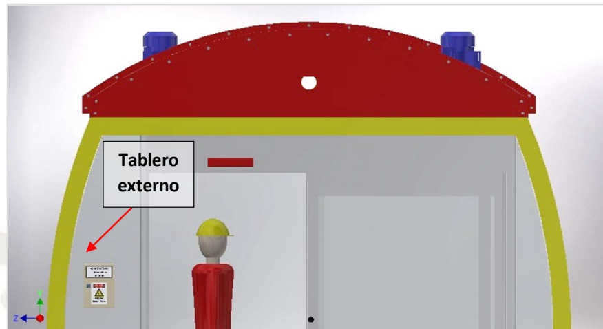
Fig. 51 Captura de ubicación de tablero remoto en una de las cabinas.
