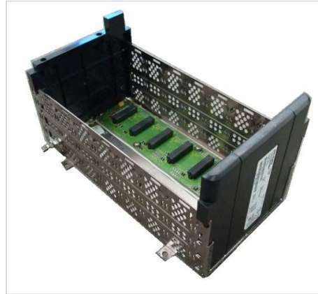
Fig. 39 Chasis Contrologix de 7 Slots. 1756-A7.
