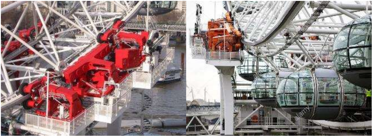
Fig. 5 - Fig. 6 Sistema de transmisión hidráulica del London Eye
