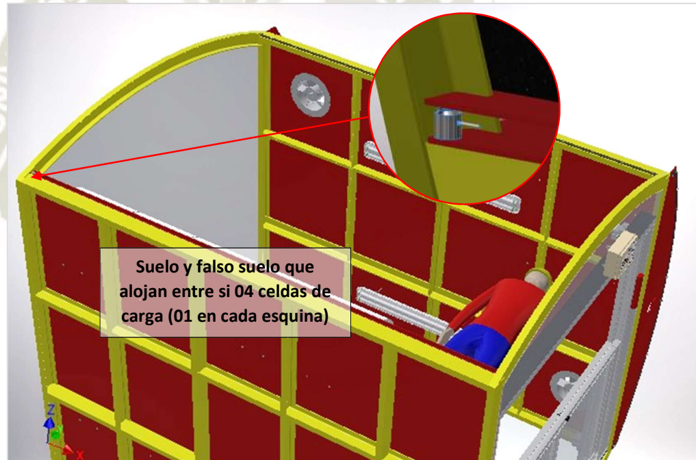
Fig. 60 Ubicación de celdas de carga entre suelo y falso suelo.
