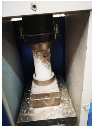
Ilustración 25.- Ruptura de probeta (4'' x 8'') ensayada a compresión
