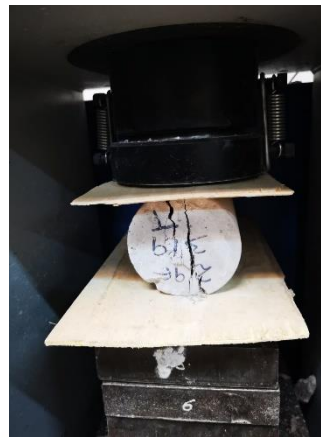
Ilustración 26.- Ruptura de probeta (4" x 8") ensayada a tracción
