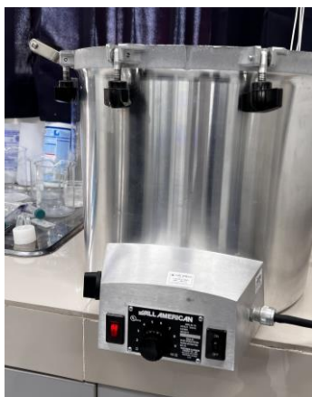
Esterilización del agar y de los instrumentos en Autoclave
