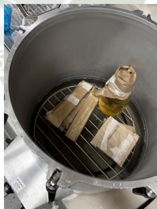
Esterilización del agar y de los instrumentos en Autoclave
