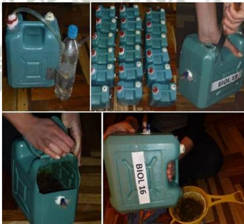
Figura 49. Recolección de biol de los digestores al final de la digestión anaerobia.
