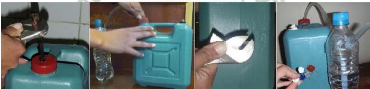
Figura 47. Elaboración de salida de gases y punto de muestreo para pH.
