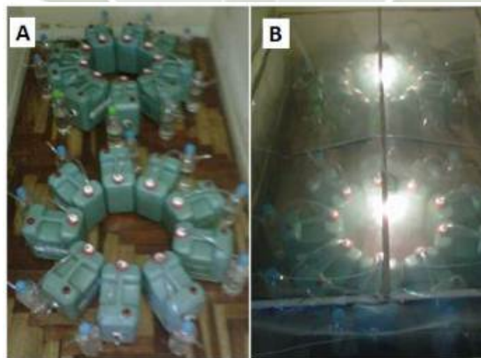
Figura 8. Lugar experimental de la Biodigestión. (A) Disposición de biodigestores, (B) Lugar experimental con soporte y reflectores.
