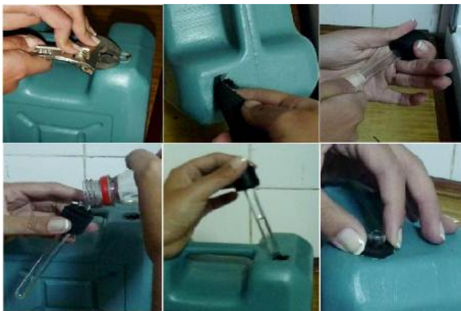
Figura 46. Elaboración del dispositivo de medición de temperatura.
