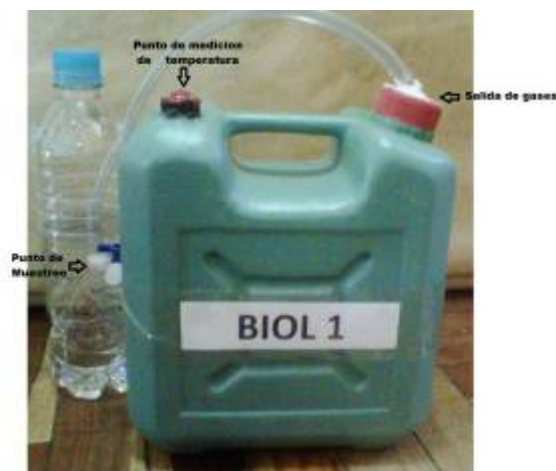
Figura 12. Imagen del biodigestor con su punto de muestreo, de medición de temperatura y salida de gases.
