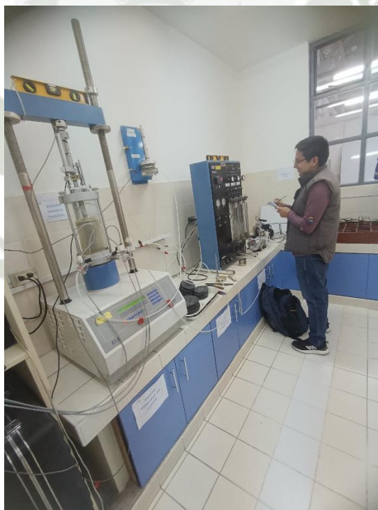
Toma de datos en ensayos triaxiales en muestra M-1 proveniente de calicata C-1
