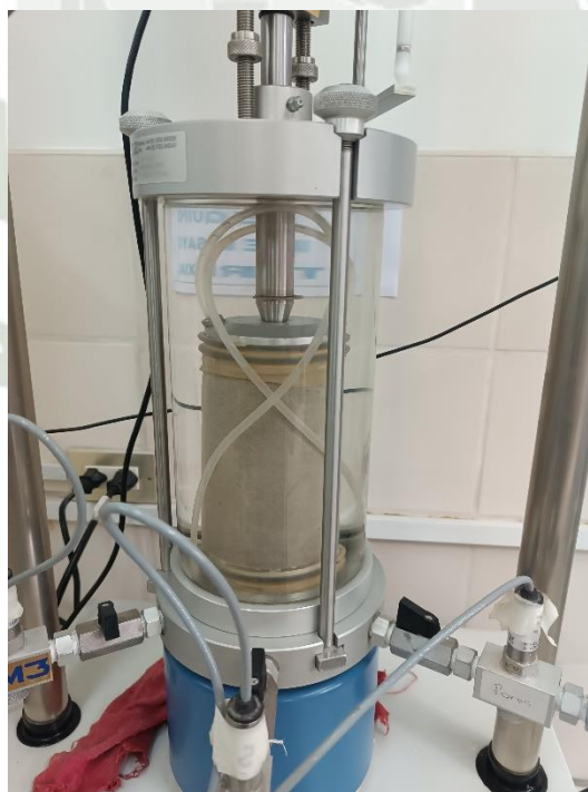
Ensayos triaxiales en muestra M-1 proveniente de calicata C-1
