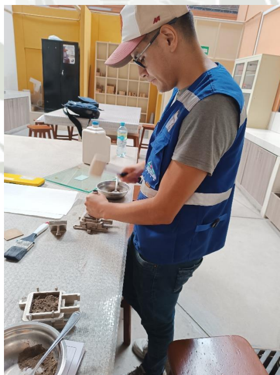
Preparación de muestra para ensayos de corte directo en muestra M-1 proveniente de calicata C-1
