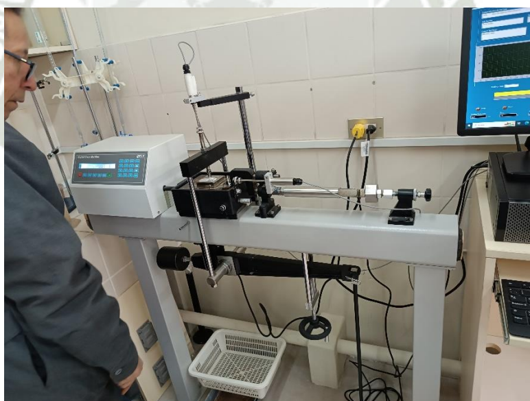
Ensayo de corte directo en muestra M-1 proveniente de calicata C-1
