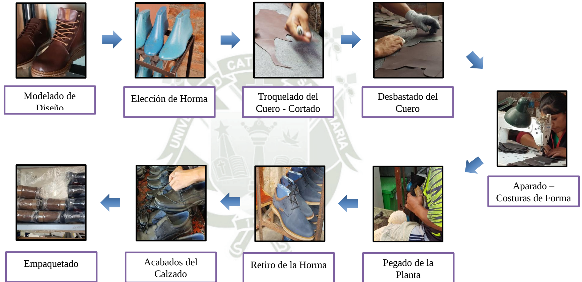
Figura 15: Diagrama general del proceso productivo de la empresa de calzado Will Hop
