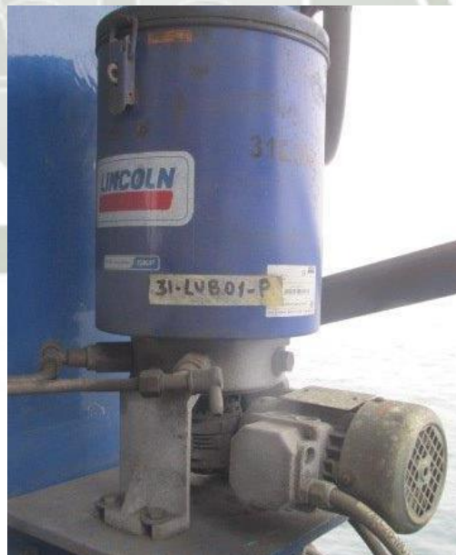
Fotografía 3.6: Bomba de Lubricación P250
