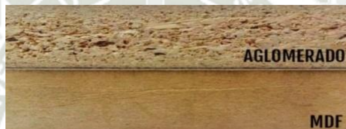
Figura 5. Corte transversal de mdp y mdf
