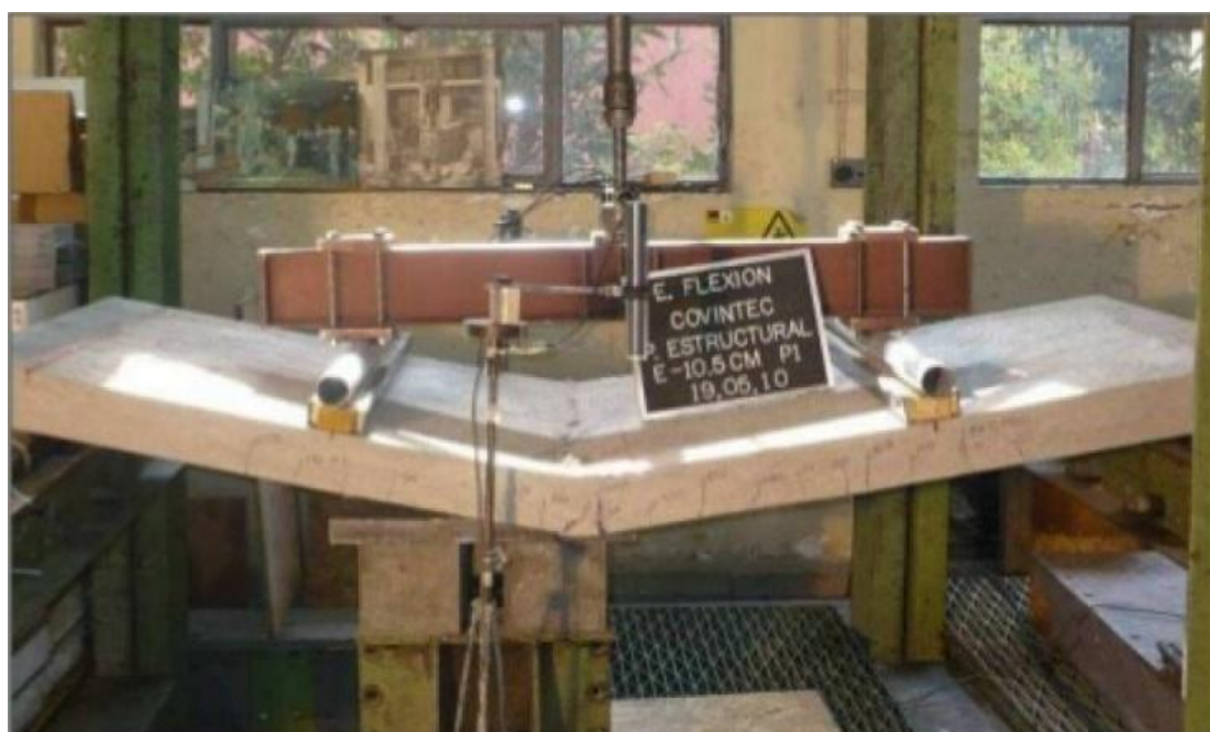
Figura 109 Modo de falla del panel
