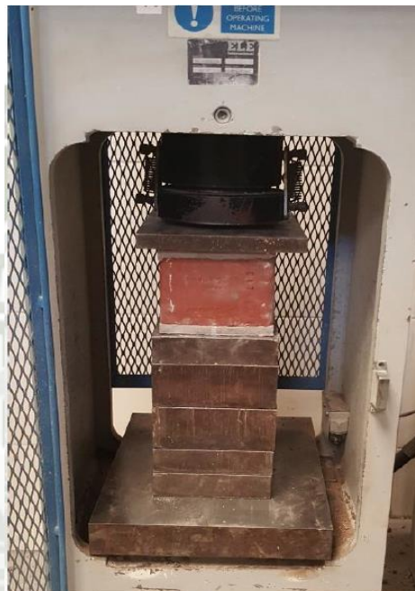
Figura 115 Ensayo a compresión de unidad de albañilería
