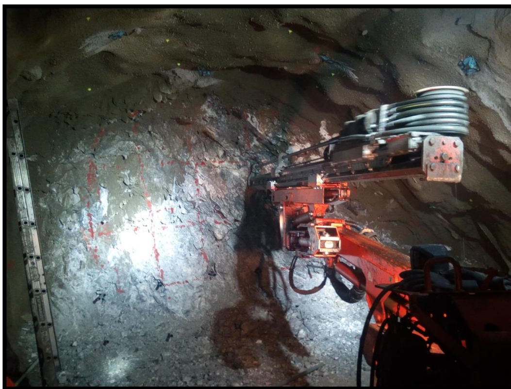
Foto 1: Jumbo perforando frente
