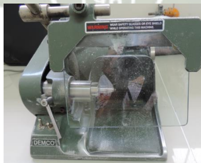
Figura 8. Máquina cortadora de discos de diamante utilizada en la investigación, para la preparación de premolares
