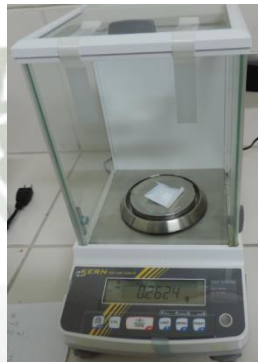
Figura 9. Balanza electrónica de precisión utilizada para la elaboración del gel de hipoclorito de sodio al 5.25%
