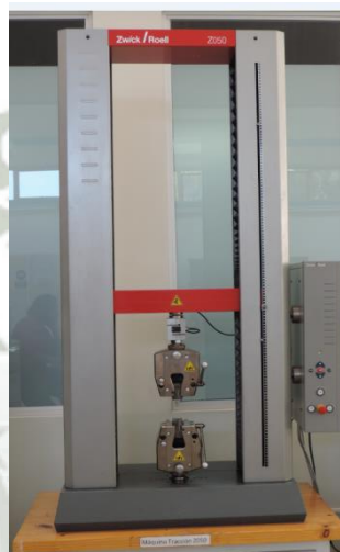
Figura 5. Maquina universal de ensayos de tracción y compresión marca Zwick/Roell, modelo Z050
