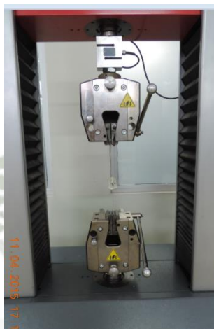
Figura 14. Maquina universal de ensayos de tracción marca Zwick/Roell, modelo Z050
