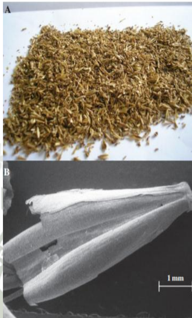
Figura 3:(A) Apariencia del bagazo de granos, (B) Imagen en microscopio de barrido de electrones. 56
