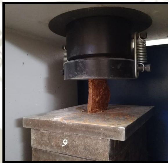
FIGURA N° 26: PRUEBA DE RESISTENCIA A LA COMPRESIÓN
