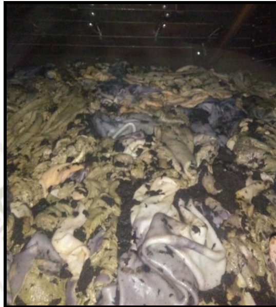
FIGURA N° 2 PIELES DESPUES DEL PELAMBRE
