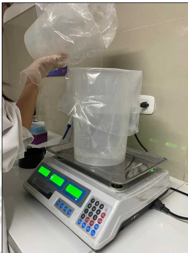
Figura 28. Medición de la cantidad de agua desionizada a utilizar
