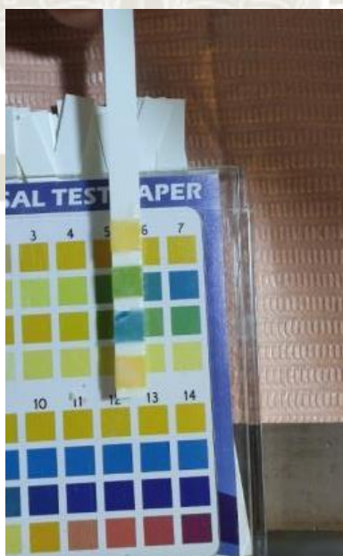
FIGURA C.4. MEDICIÓN DEL PH DEL LÁTEX CON TIRAS MEDIDORAS DE PH FUENTE: PROPIA
