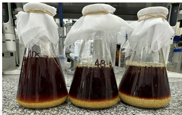
Figura 23. Adsorción con resinas ADS-7 (izquierda), AB-8 (centro) y HPD-100 (derecha).
