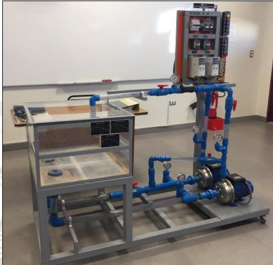
Figura 30. Producto final, banco de pruebas de bombas centrífugas en serie y paralelo, dimensiones largo 1.80 m., ancho 0.70 m y altura 1.60 m, Q=20-80 litros/minuto, Potencia 1.05 KW, Potencia hidráulica de 0.75 KW (Fuente: Elaboración Propia).
