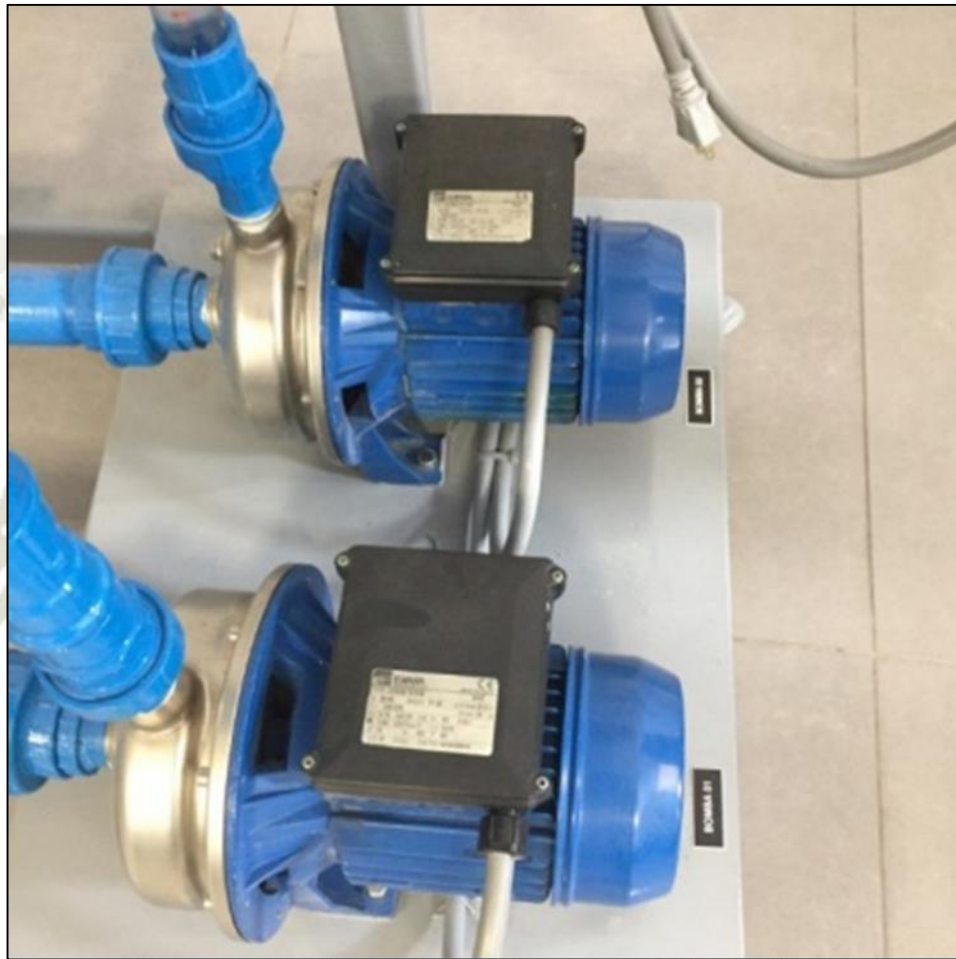
Figura 33. Bombas centrífugas de módulo caudal máximo 80 litros/minuto una altura máxima de 32 metros, potencia eléctrica de 1.05 KW y potencia hidráulica de 0.75 KW (Fuente: Foto real de las bombas del banco de pruebas)
