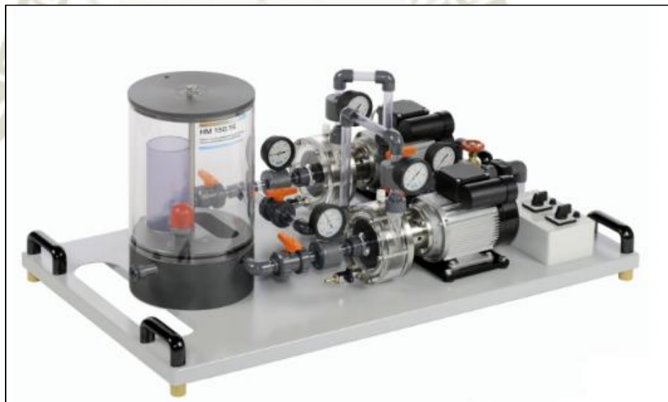
Figura 28. HM 150.16 Conexión en serie y en paralelo de bombas (Fuente: https://www.gunt.de )
