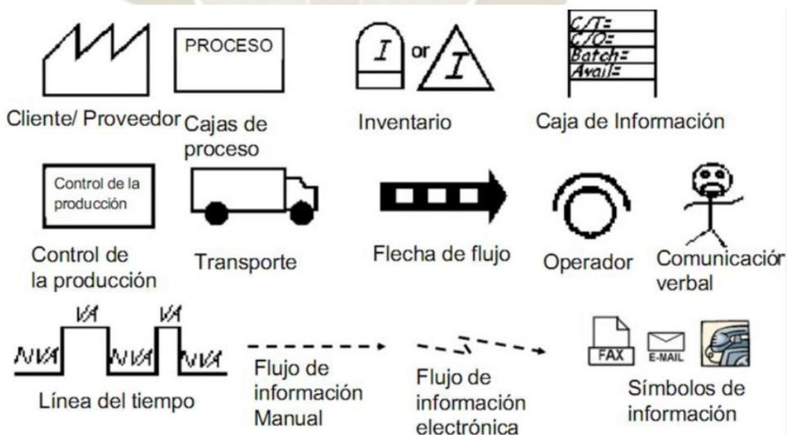
Figura 27. Representación de la herramienta Value Stream Mapping
