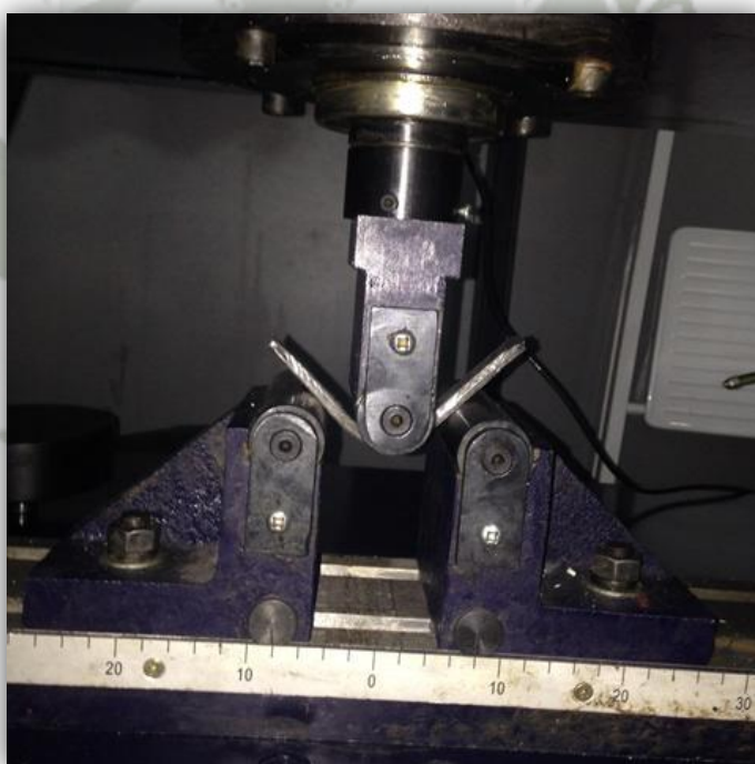
Figura 58. Deflexión de la probeta
