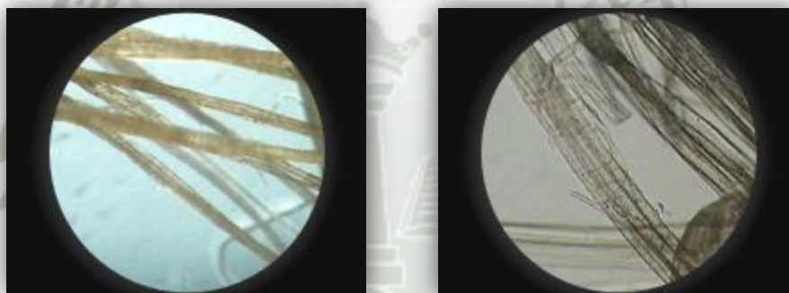
Figura 21. MICROGRAFÍA: Fibra de yute al microscopio (vista longitudinal)
