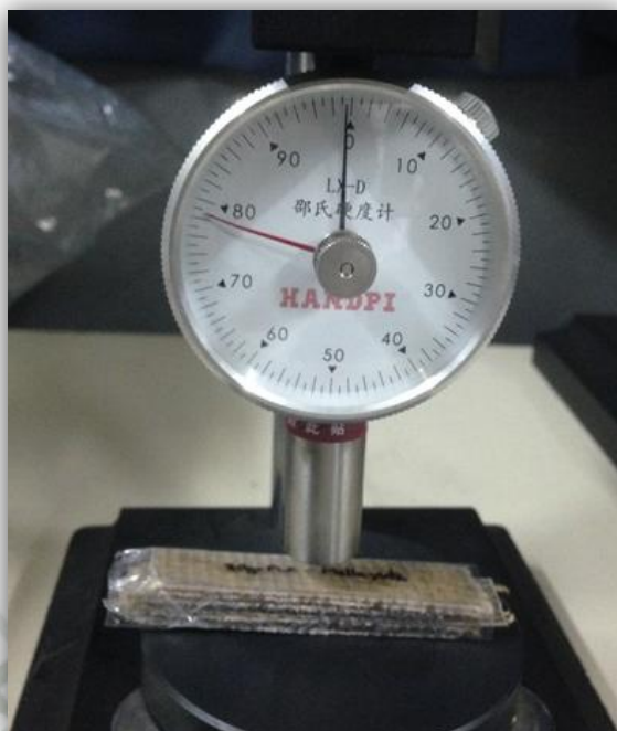
Figura 68. Probeta sobre superficie plana y dura
