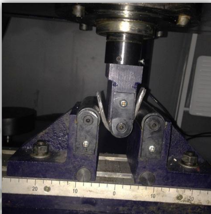
Figura 59. Deflexión de la probeta al final del ensayo
