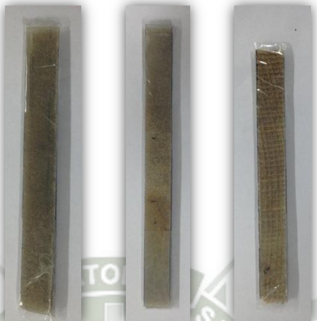
Figura 55. Probetas por cada lámina (flexión)
