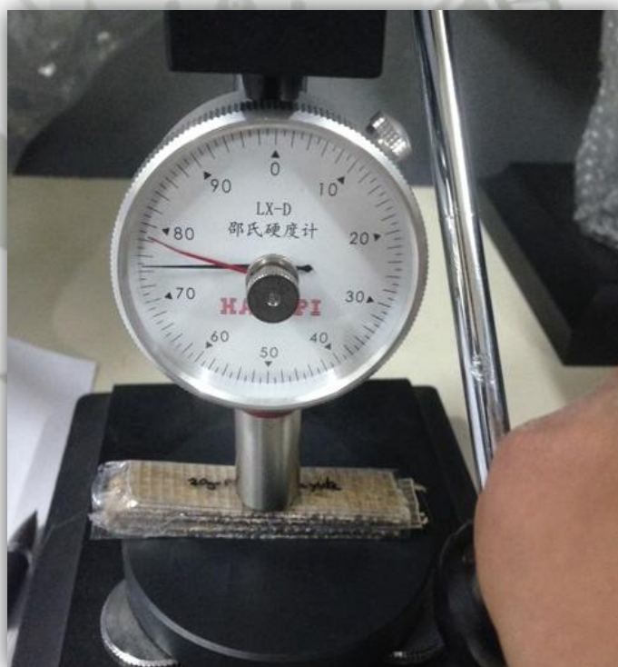
Figura 69. Indentador presionando la muestra
