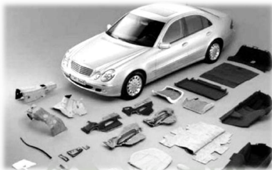
Figura 14. Componentes que tienen incorporadas fibras naturales Mercedes-Benz en 1996 en vehículos clase E.
