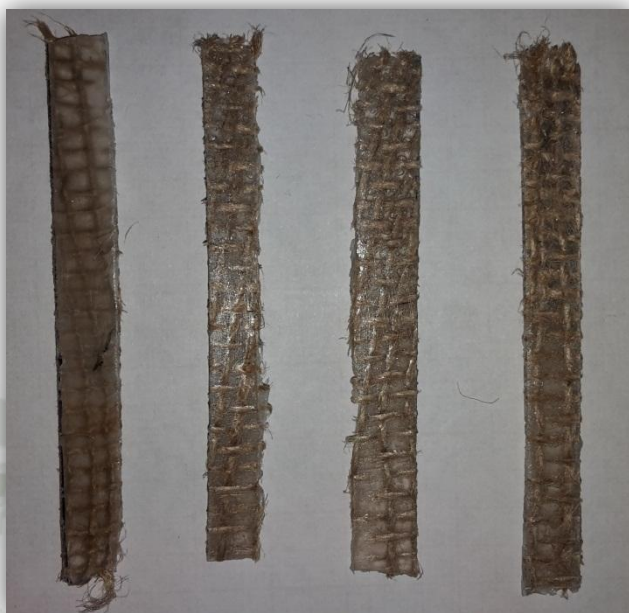
Figura 62. Probetas compuestas Yute con malla
