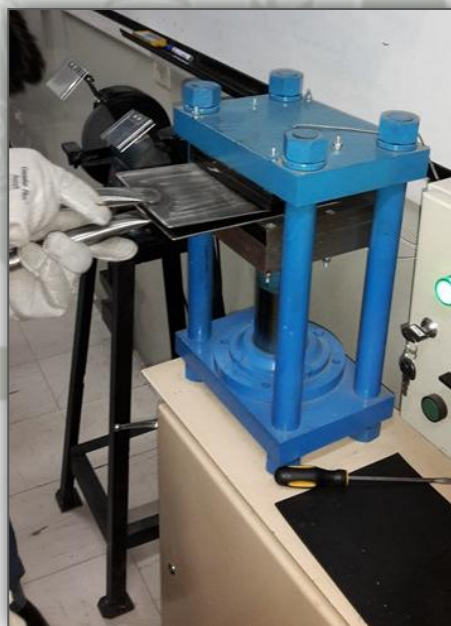
Figura 43. Colocación de Placas con PLA en prensa Hidráulica
