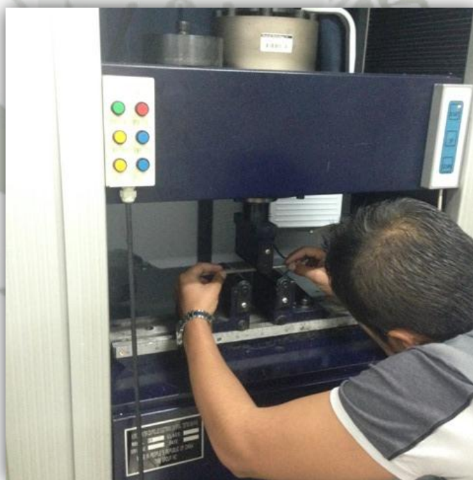
Figura 56. Montaje de la probeta (flexión)
