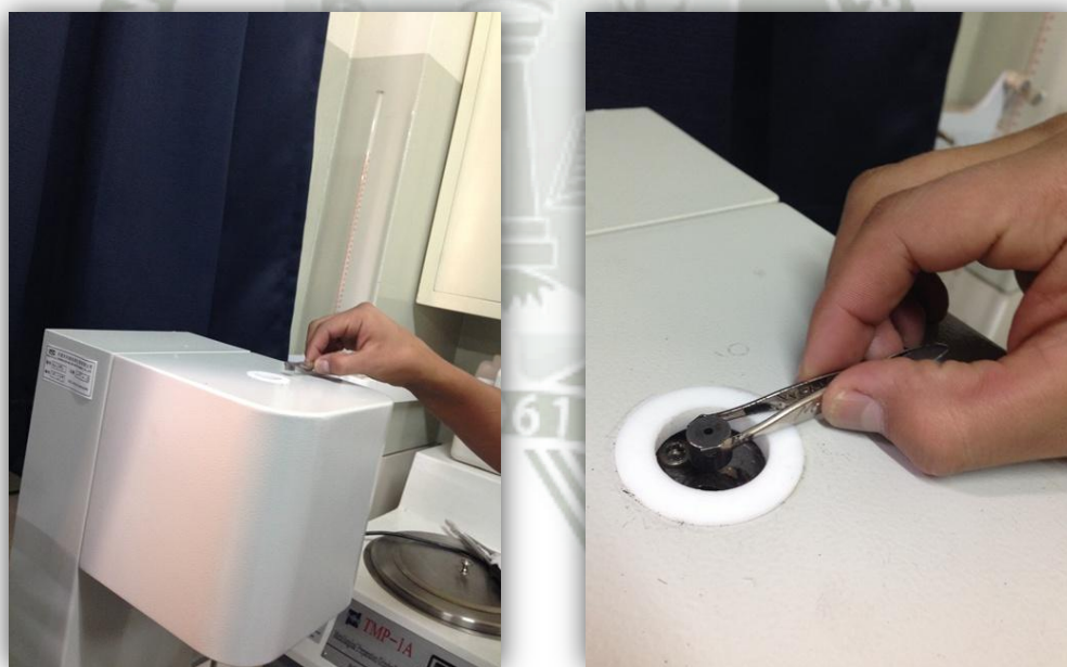
Figura 74. Montaje del dado
