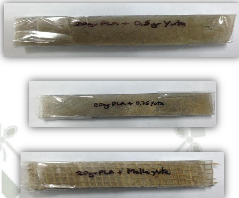
Figura 66. Probetas preparadas (dureza)
