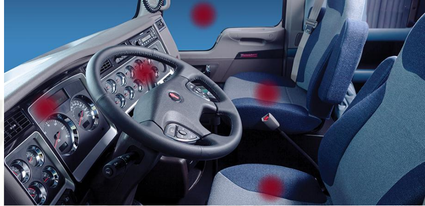
Figura 37. Puntos de limpieza interno
