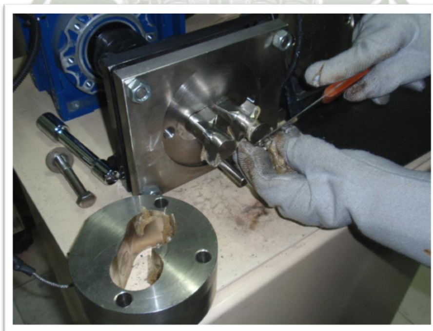
Figura 2.28 Extracción del compuesto de la Cámara de mezcla abierta del Brabender
