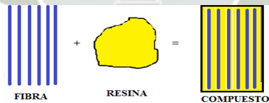
Figura 1.16 - Formación de un material compuesto usando una resina y fibras
