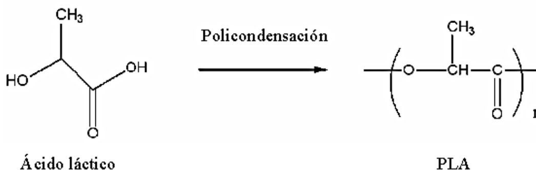
Figura 1.6. Policondensación del PLA.
