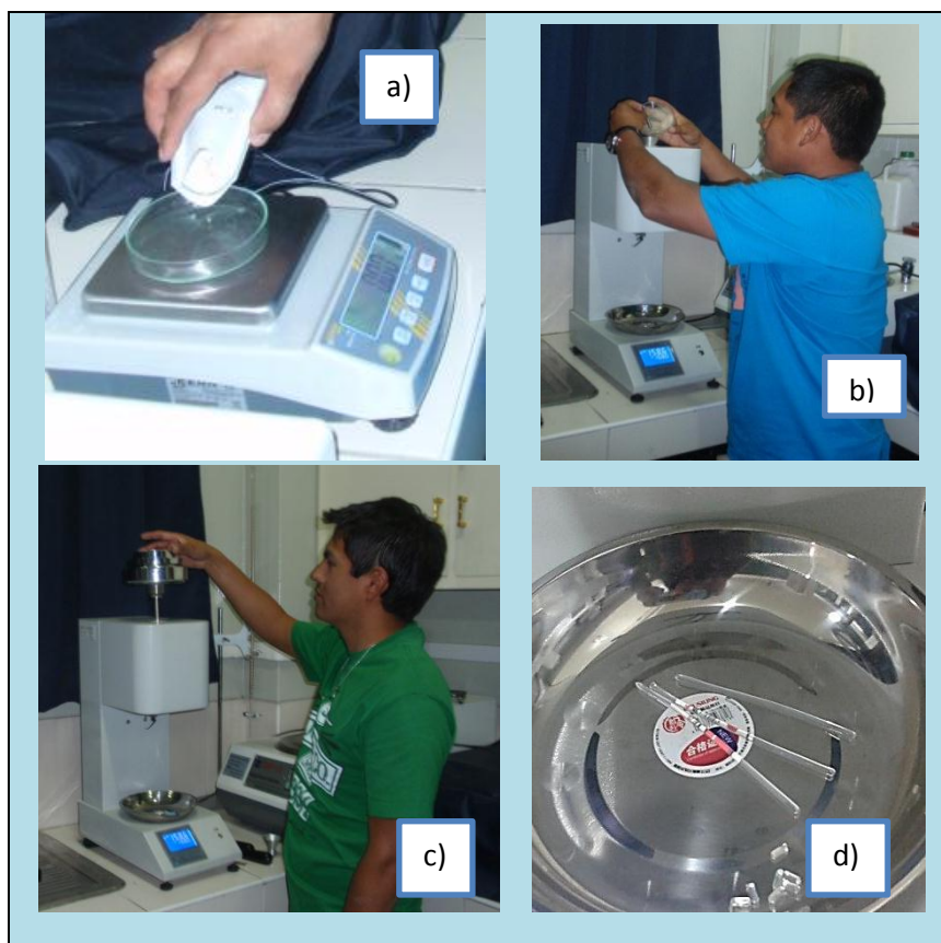
Figura 3.10: a) Pesada de las muestras, b) colocado de la muestra en el equipo c) Colocado de las pesas y d) Muestras Obtenidas
