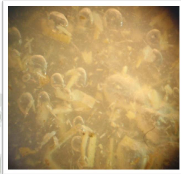
Figura 3.21: Probeta de PLA con 0.5 gr de Cascara de arroz vista al microscopio
