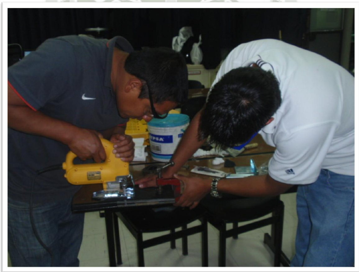
Figura 2.33 Corte para la fabricación de probetas
