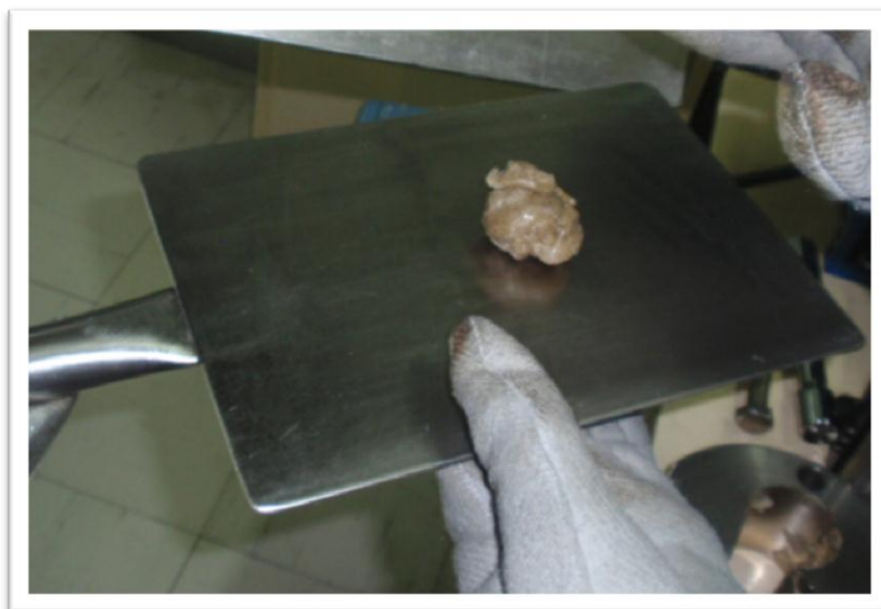
Figura 2.31 Material extraído del Brabender colocado en las paletas de acero inoxidable.
