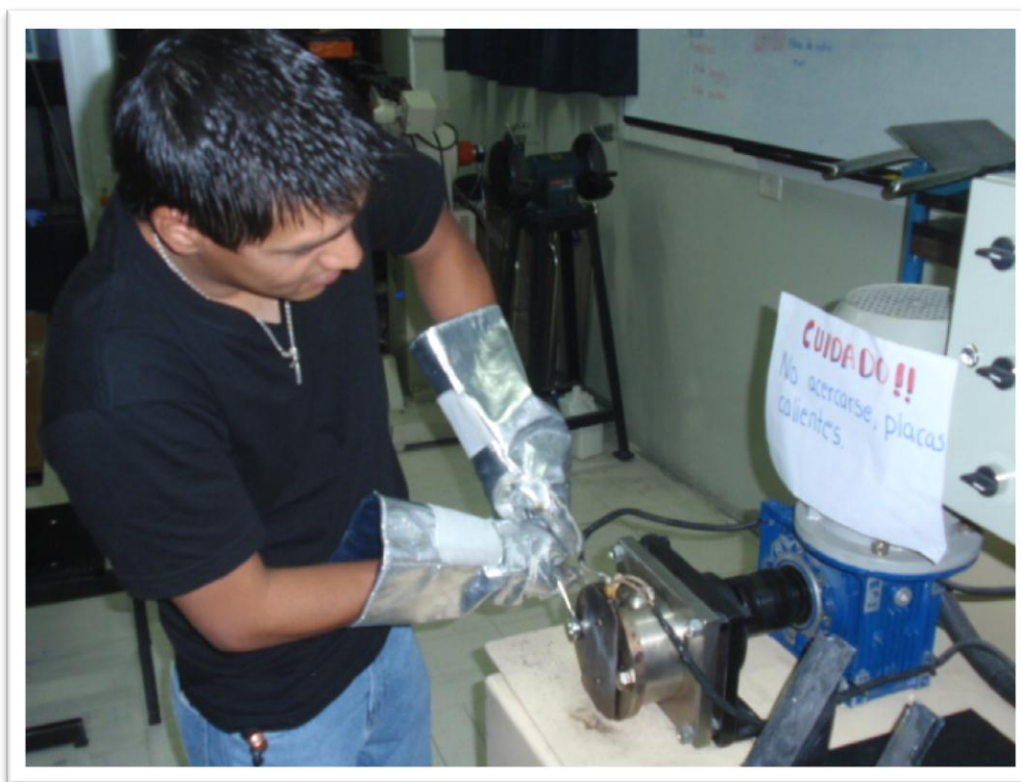
Figura 2.27 Abertura de la cámara de mezcla del Brabender
